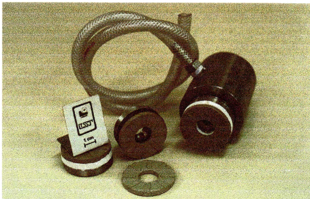
Figura 4. 8- Detalhes do cabeçote de lapidação e rebolos.
