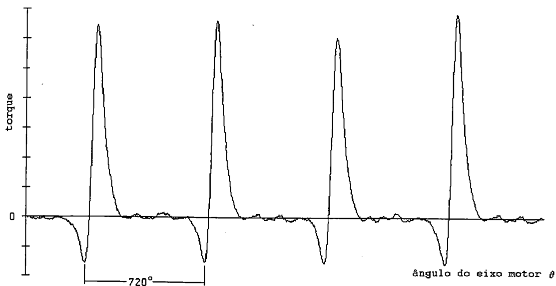
Figura 7- Torque devido ao gás em um cilindro 21 , em função do ângulo do eixo motor.
