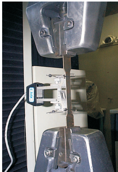
Figura 6.15: Montagem do CDP no ensaio de tração
