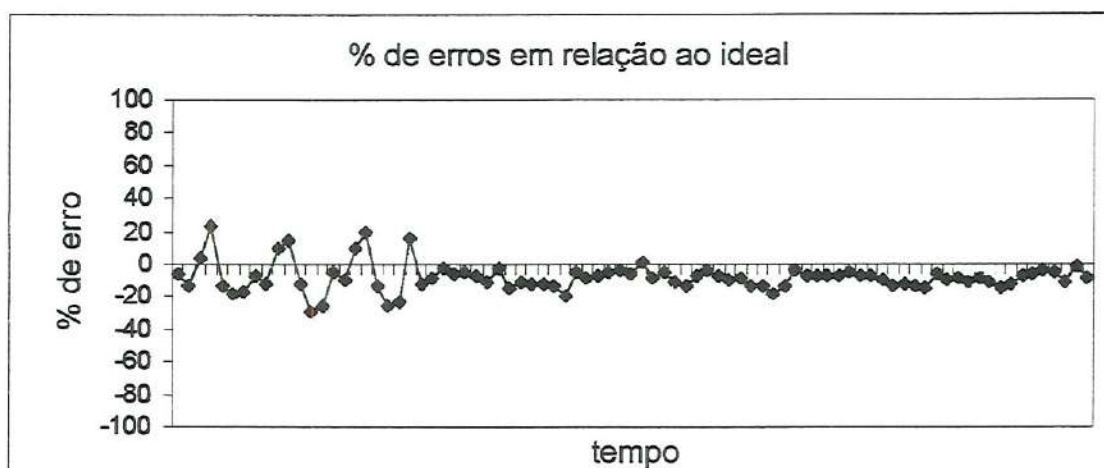
Figura 4.38 – Variações das proporções do traçador, U_{FL} = 1,7U_{MF} . Exp. 2a.
