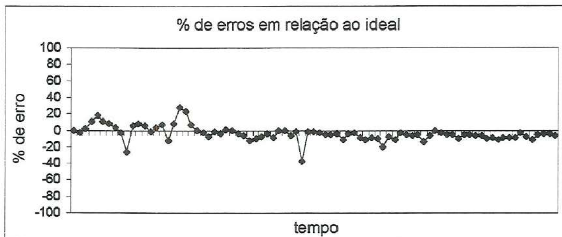
Figura 4.41 – Variações das proporções do traçador, U_{FL} = 2,0 U_{MF} . Exp. 3a.
