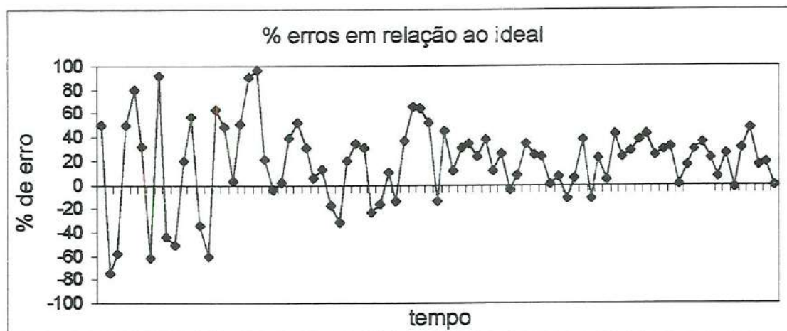
Figura 4.36 – Variações das proporções do traçador, U_{FL} = 1,4 U_{MF} . Exp. 1b.
