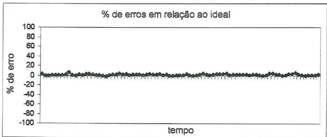
Figura 4.51 – Variações das proporções do traçador, U_{FL} = 2,0 U_{MF} . Exp. 6b.
