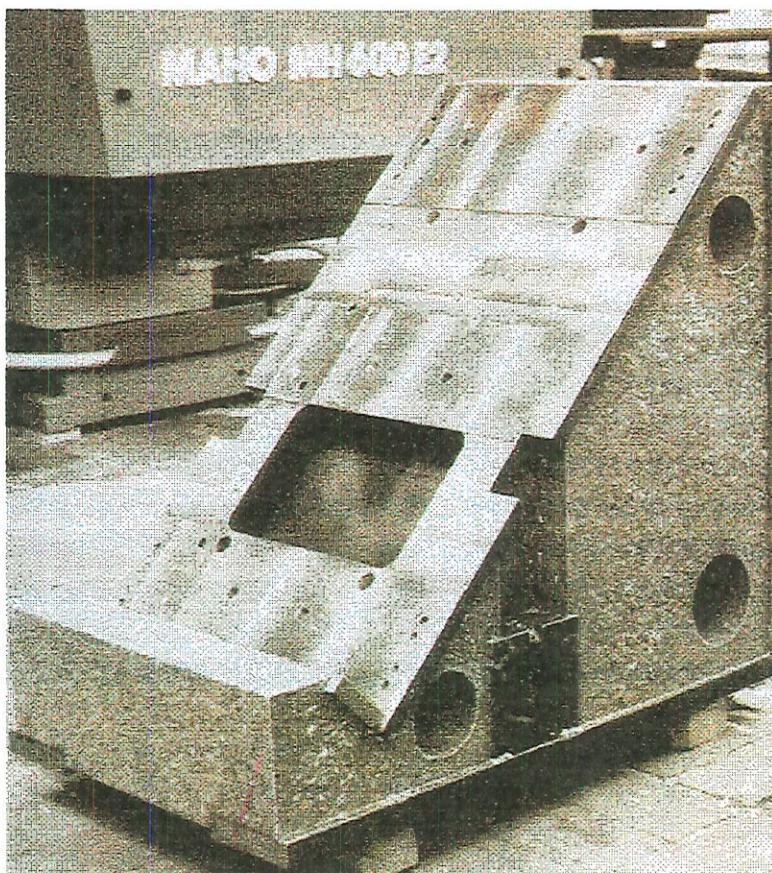
Figura 3.9 – Aplicação de granito sintético em dispositivos de fixação. (WIEKE, 1998)
