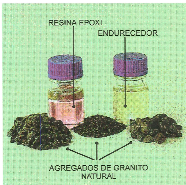
Figura 3.5 – Composição do granito sintético. (SYNCONCRETE, 1993)
