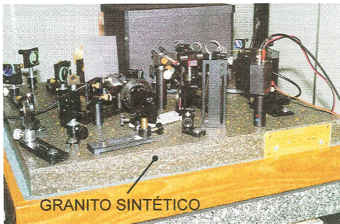
Figura 3.8 - Aplicação de granito sintético em bancadas ópticas (LAMAFE- USP).
