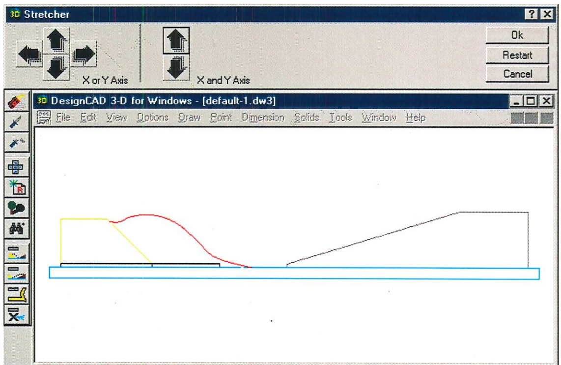
FIGURA 21 - Tela de esboço, apresentando-se a mina em corte lateral para definição do volume de material a ser removido
