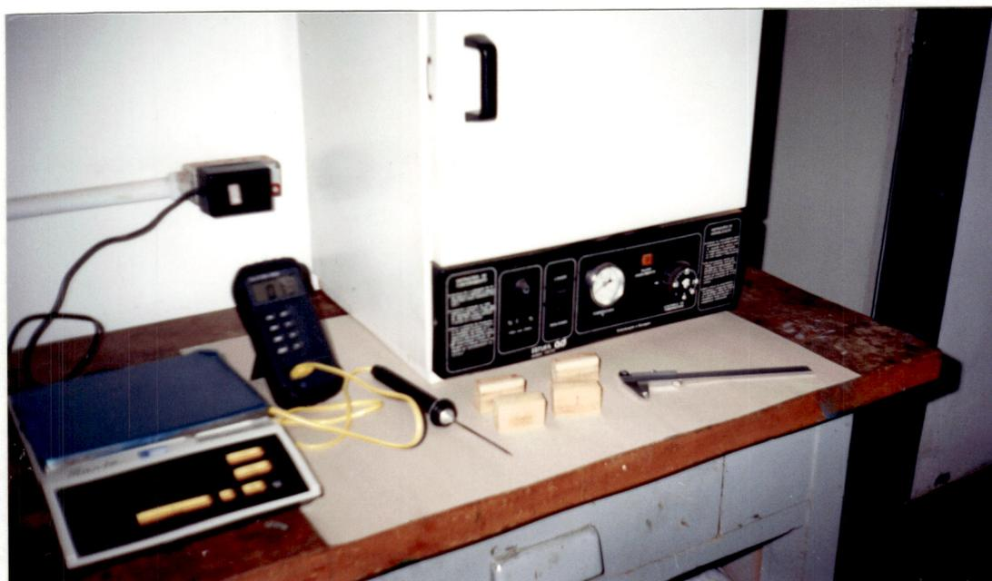
Figura 3.17 - Equipamentos utilizados na determinação do teor de umidade das amostras de madeira
