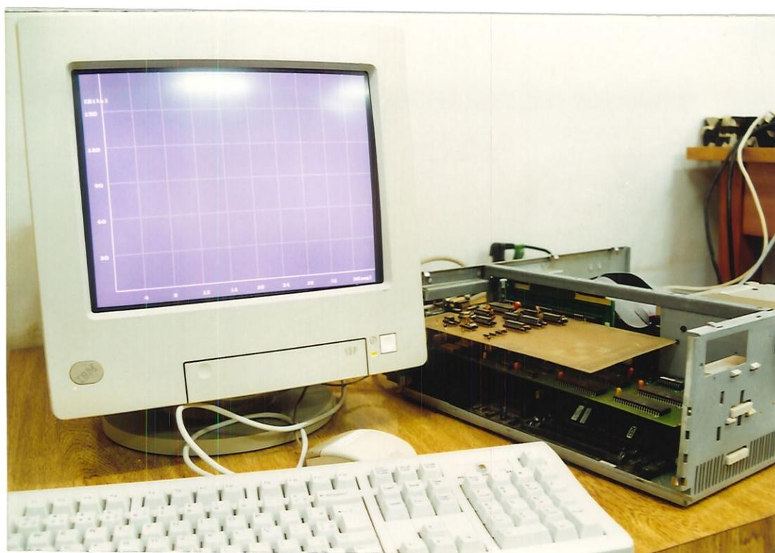
Figura 3.10 - Detalhe da placa de interface para medição da força de corte e tela de espera para início de ensaio.
