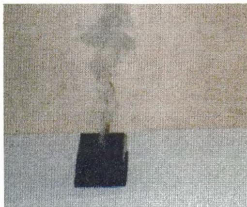
FIGURA A.2 - gerador de fumaça utilizado na calibração do micro-túnel de vento.
