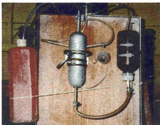
FIGURA A.1 - gerador de fumaça utilizado nos ensaios preliminares.
