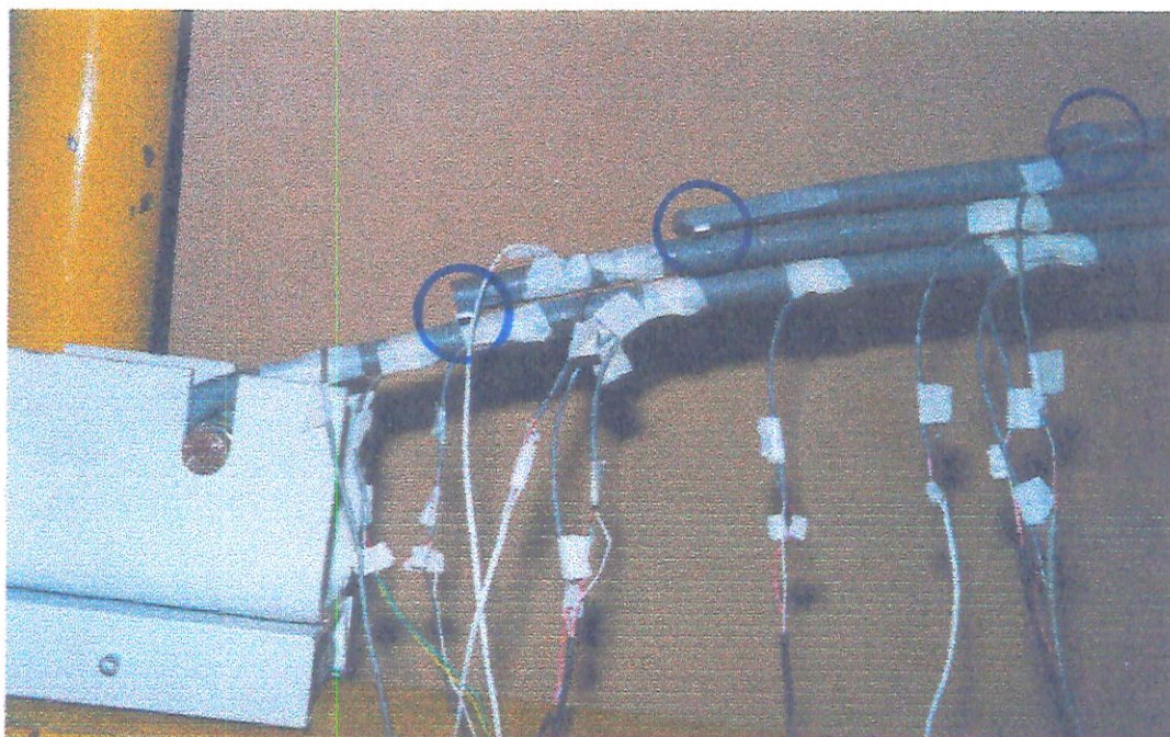
FIGURA 3.10 - Ensaio com barras espaçadoras para determinação precisa dos pontos de carregamento.
