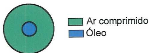
FIGURA 4.16 – Condução do ar comprimido e do óleo em mangueiras separadas, da unidade de controle até o bico aspersor.
