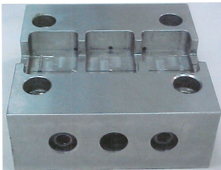
FIGURA 4.5 – Dispositivo de fixação do corpo-de-prova.
