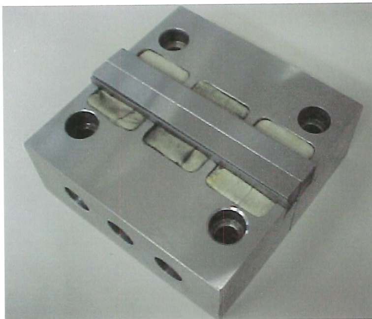
FIGURA 4.7 – Corpo-de-prova montado no dispositivo de fixação.
