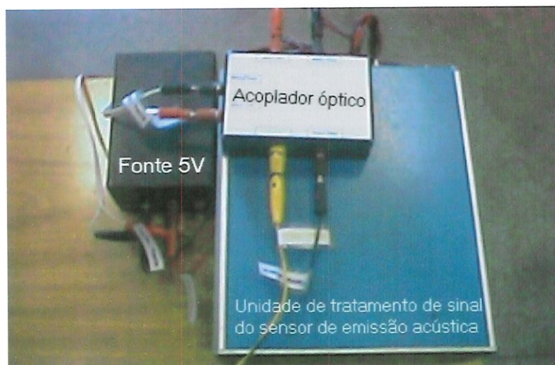
FIGURA 4.13 – Unidade de tratamento de sinal do sensor de emissão acústica e o acoplamento óptico.
