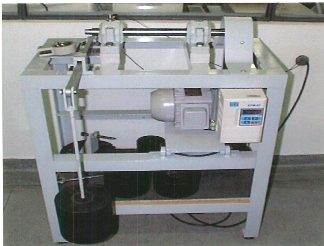
FIGURA A1.3 – Vista principal da bancada: detalhes do suporte do rolamento de teste e da ponta de eixo desmontados.
