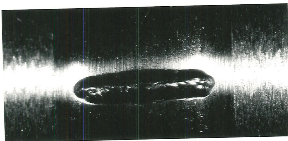
FIGURA A2.4 – Falha usinada na pista interna tipo risco (FAG E-20; A \approx 3 mm 2 ).
