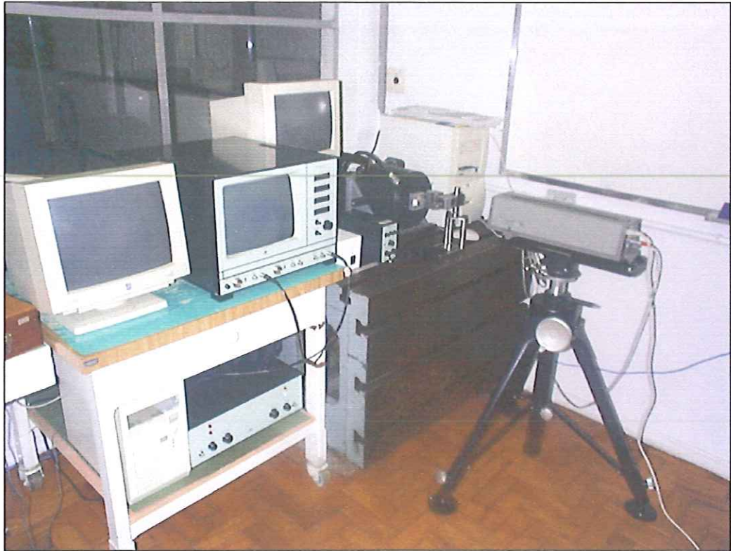
Figura 3.7 – Calibração utilizando interferometria laser
