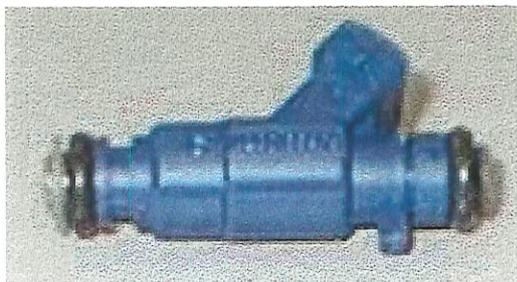
Figura 5.6: Foto de um injetor sem a carcaça metálica.
