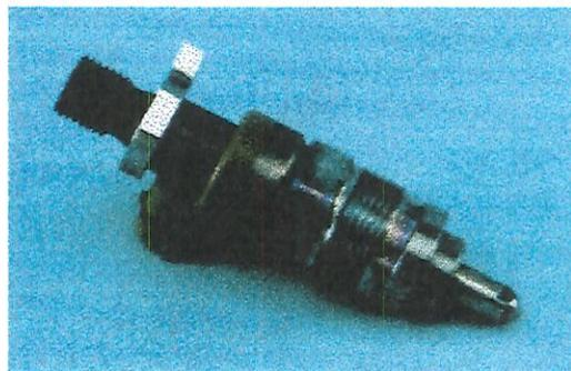
Figura 3.5: Bico injetor de combustível (YAMAGUCHI, 1997).
