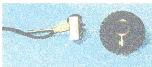
Figura 3.5- Fotografia mostrando o disco do “Encoder” e o sensor foto-elétrico.
