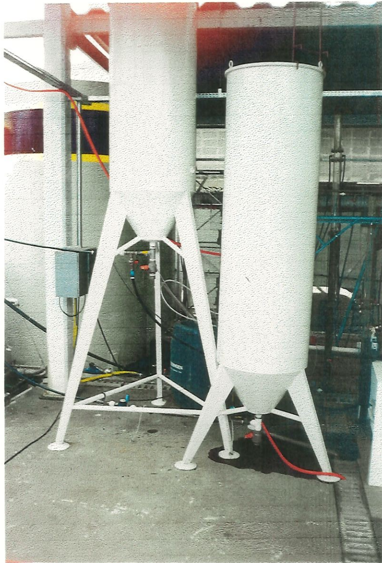
FIGURA 4.8 - VISTA FRONTAL DO FILTRO ASCENDENTE DE PEDREGULHO (FPA)
