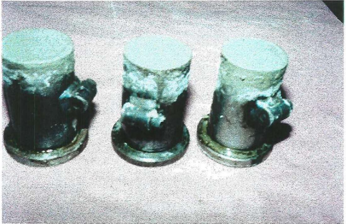
FIGURA 4.7 - Moldagem dos corpos de prova para o ensaio de resistência à compressão
