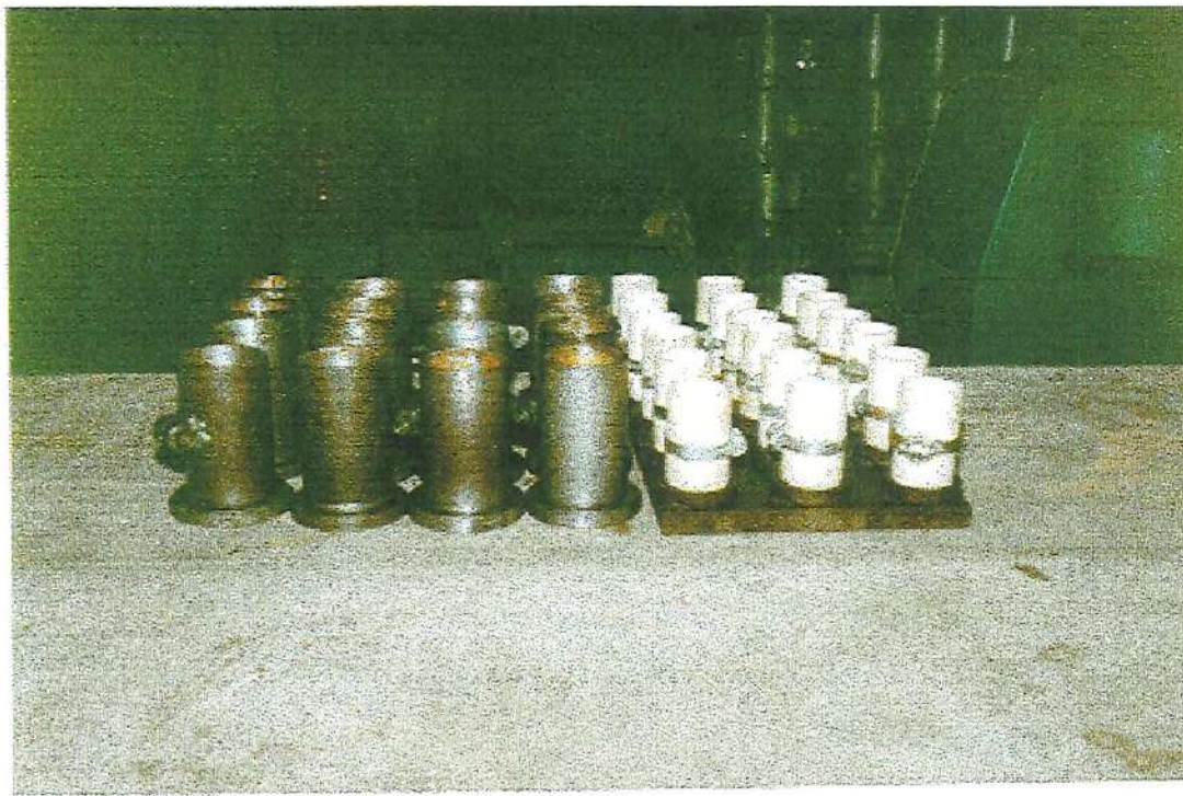
FIGURA 4.6 - Moldes para os ensaios de resistência à compressão (à esq.) e para os ensaios de lixiviação e solubilização (à dir.)
