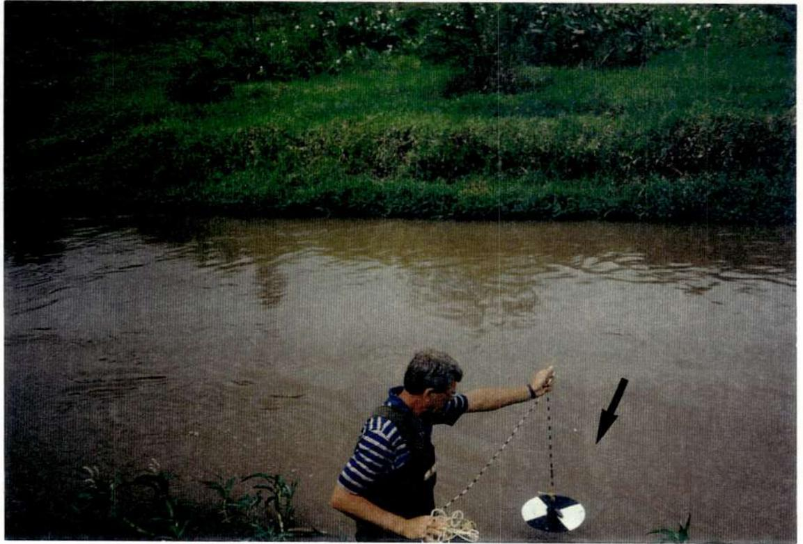
FIGURA 5.17: Disco de Secchi utilizado para medir a transparência da água nos pontos de coleta.
