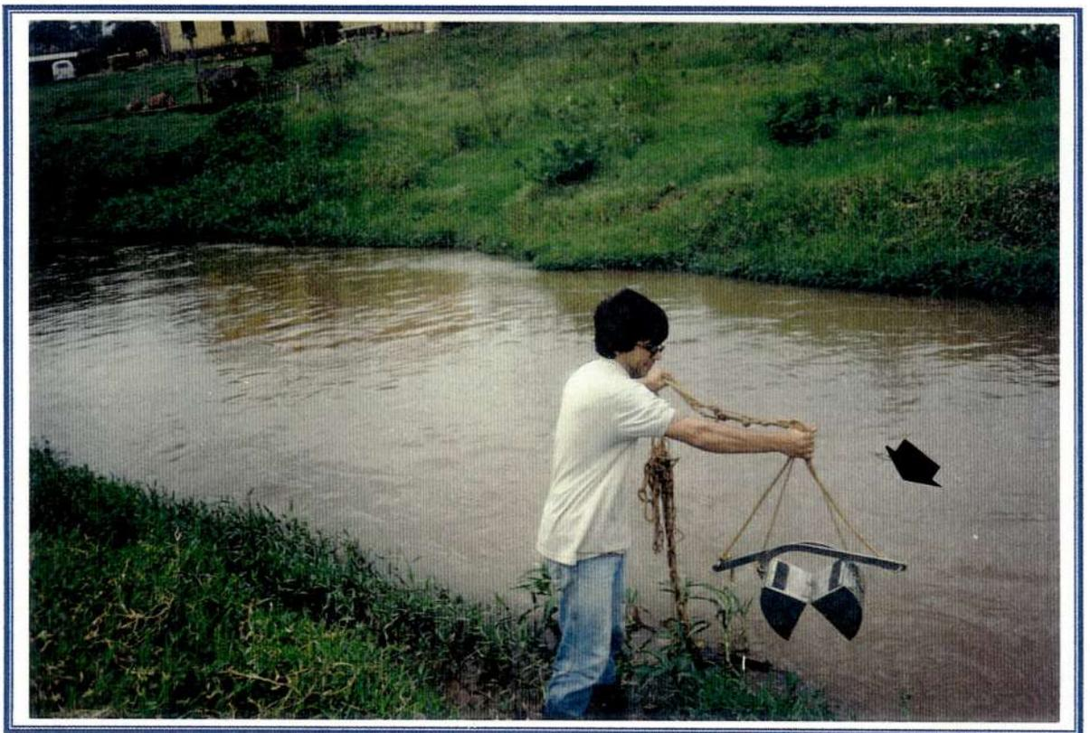
FIGURA 5.16: Draga de Van Veen utilizada para coleta da comunidade bentônica (em todos os pontos de amostragem) e sedimento (nos pontos 2, 3, 4, 5, 6, 7 e 8).
