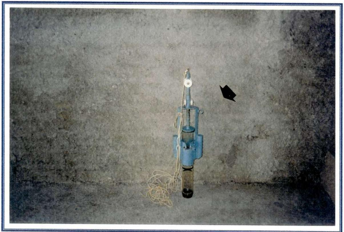
FIGURA 5.13: Perfilador utilizado para coleta de sedimento até a profundidade de 15 cm nos pontos 1 e 9.
