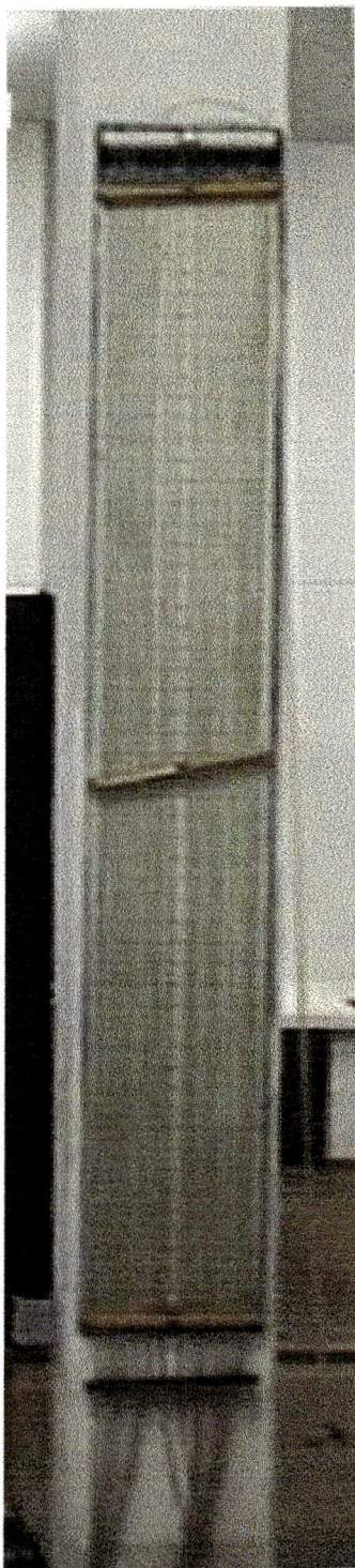
(a) - Manômetros de água
