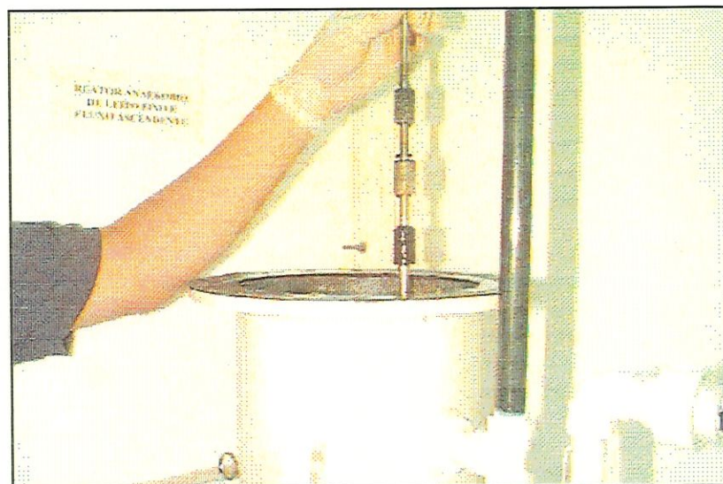
Figura 4.8- Retirada do módulo longitudinal do reator para transferência do suporte colonizado para o reator diferencial.
