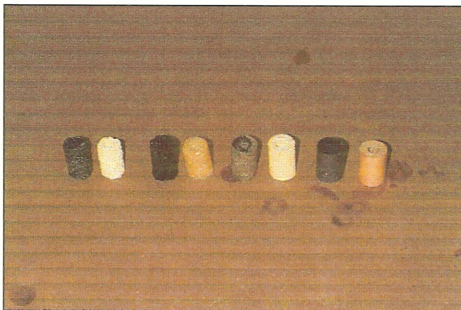
Figura 4.6- Suportes inertes utilizados em duas situações distintas, antes (direita) e após (esquerda) formação do biofilme. Da esquerda para direita: Par 1 → material cerâmico poroso; Par 2 → material polimérico poroso; Par 3 → material cerâmico não poroso; Par 4 → material polimérico não poroso.
