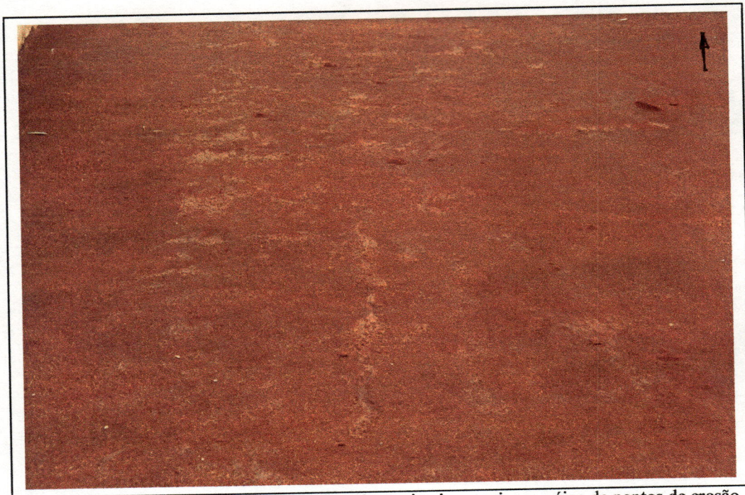
Foto 19. Estado da superfície do solo após o primeiro ensaio: mosaico de pontos de erosão precusores da formação de microcanais e do microrrelevo
