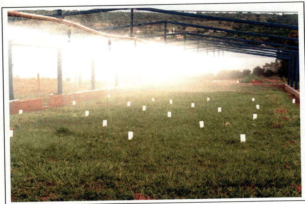
Foto 12. Simulador pressurizado: avaliação da pluviometria e teste de uniformidade de distribuição
