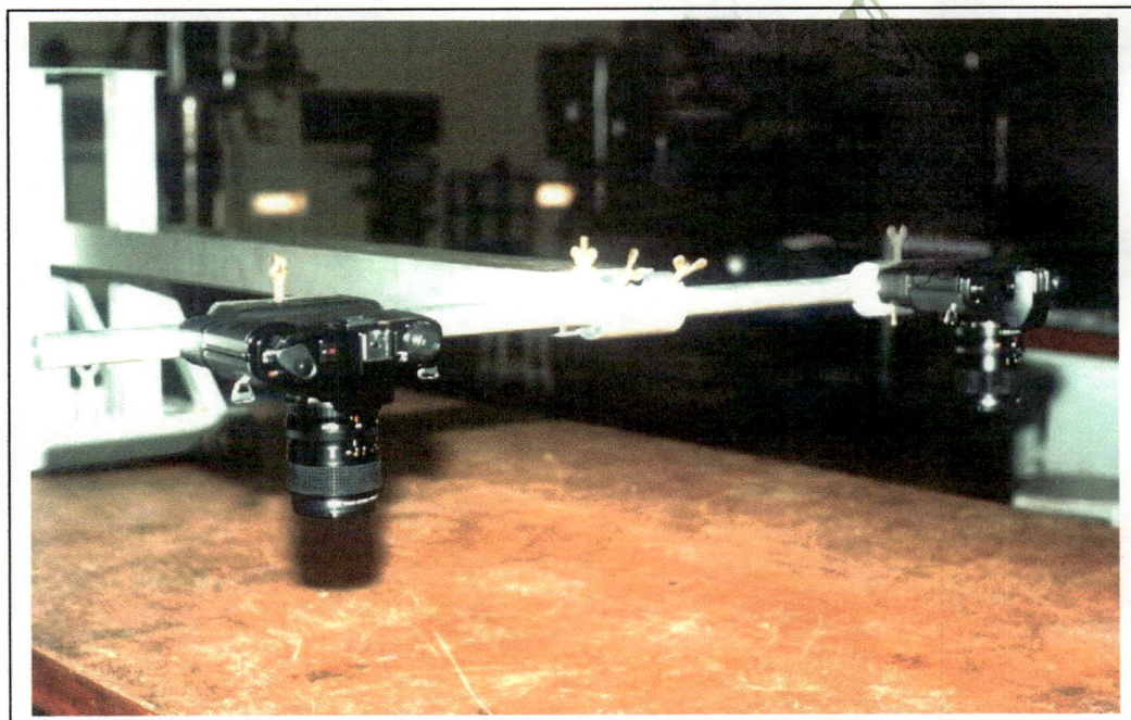
FOTO - 2. Sistema fotogramétrico montado com duas câmeras Minolta X-300S
