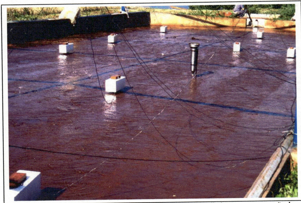
Foto 21. Processo de formação do microrrelevo e a sua contribuição na concentração do escoamento (faixas de escoamento)
