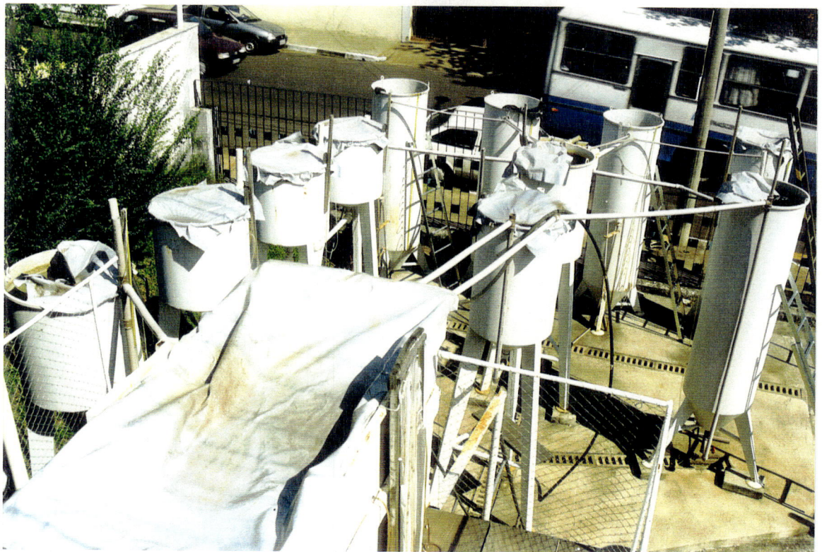
FIGURA 4.3 Vista da instalação piloto, destacando-se na parte inferior esquerda o PFD 2, a esquerda as quatro unidades da linha 01 de PFPA, ao centro duas unidades da linha 02 de PFPA, a direita o PFPA 1234.
