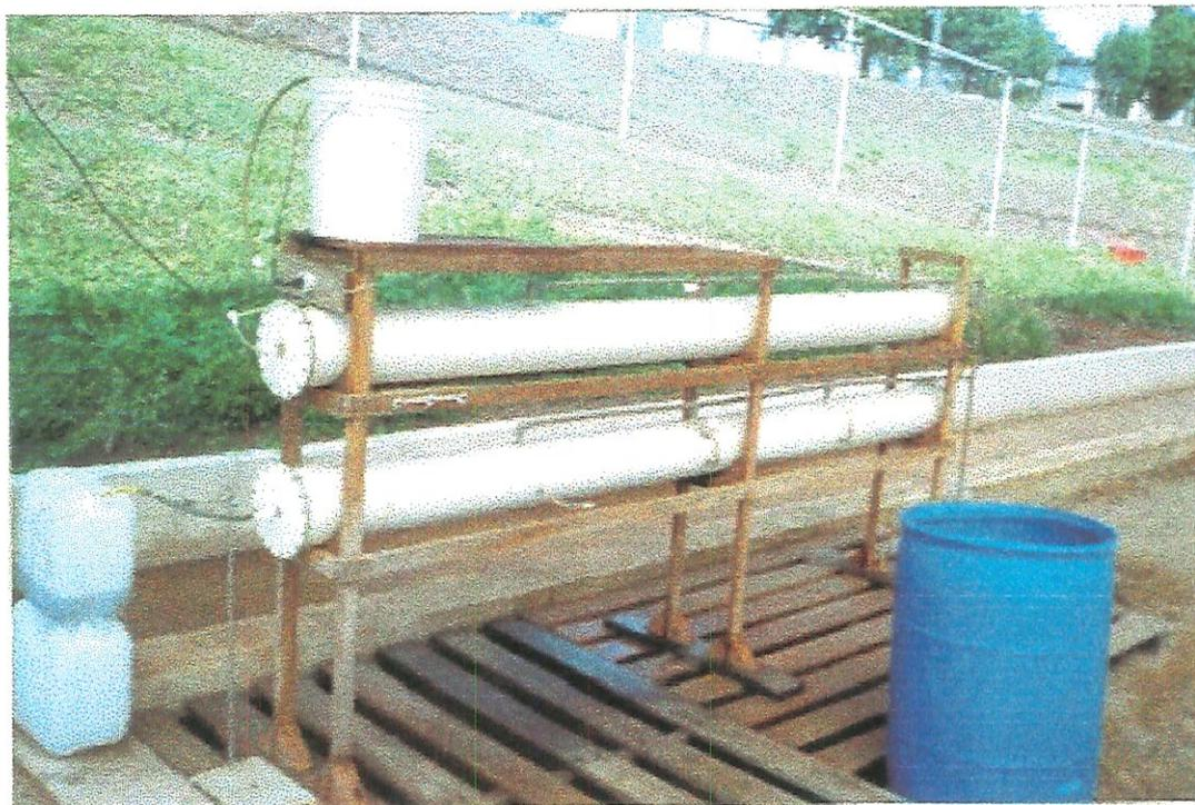
FIGURA 3.2 - Reator Anaeróbio de Leito Fixo e Escoamento Horizontal, Montado em Área Coberta na Indústria de Peróxidos Orgânicos Onde se Realizou a Fase Experimental Deste Trabalho
