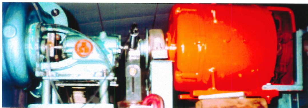
Figura-Foto B - Detalhe da peça acoplada a gaxeta, tacômetro e vista geral do conjunto moto - bomba
