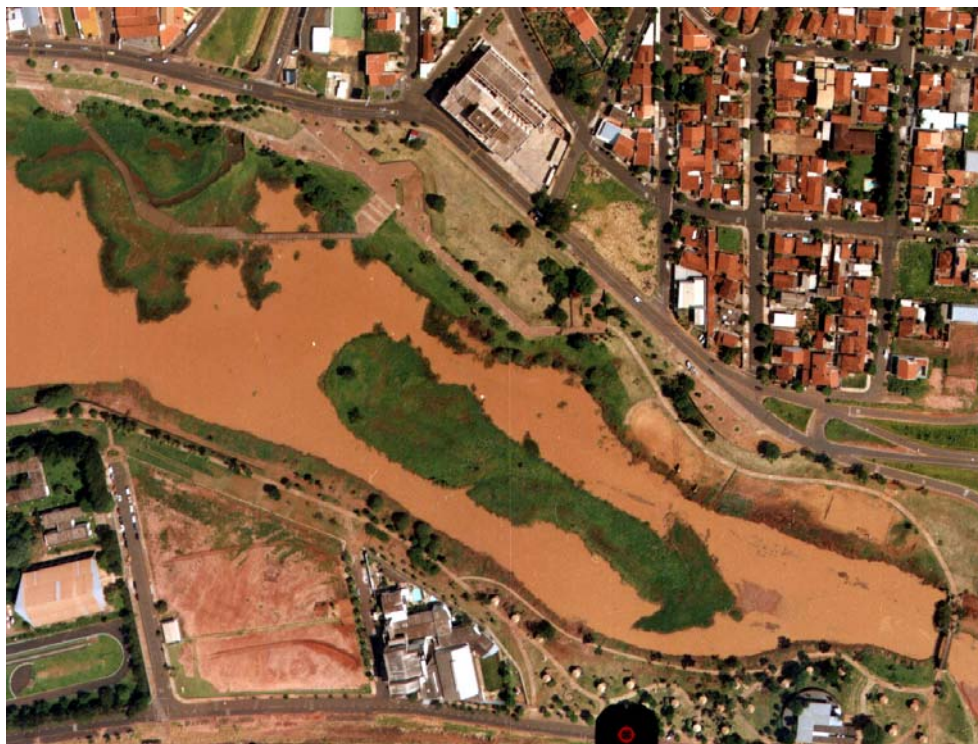
FIGURA 26 – Foto aérea mostrando detalhe do assoreamento ocorrido na represa. Fonte: Prefeitura de São José do Rio Preto.
