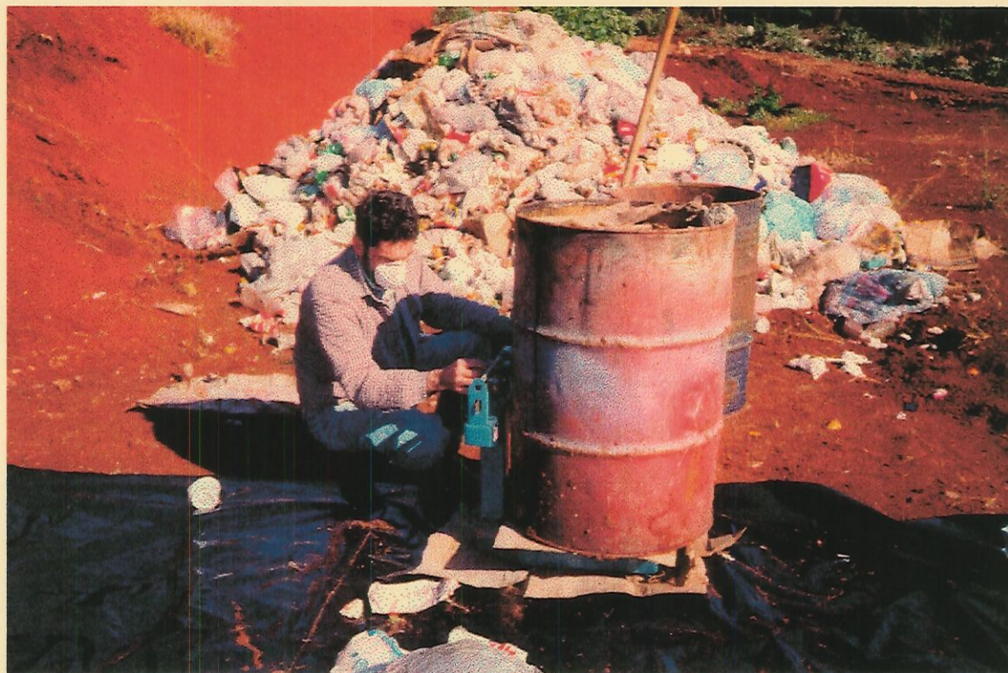
Figura 09 - Pesagem dos diversos materiais com fins de fazer a caracterização qualitativa dos resíduos sólidos domiciliares, realizado no próprio lixão da cidade de Pato Branco.
