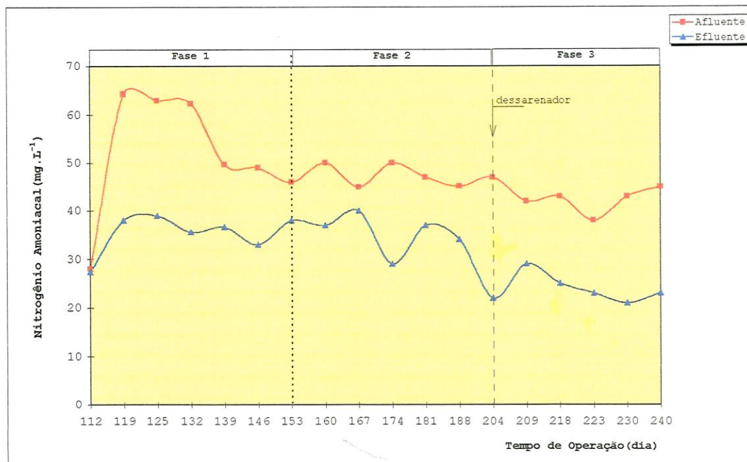
Figura 5.57. Variação do nitrogênio amoniacoal do afluente e do efluente do RALE x .
