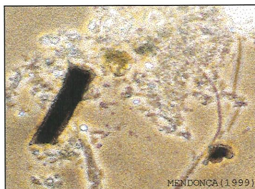
Figura 5.73. Microscopia de contraste de fase do material biológico desprendido por sonicação (objetiva 100; ocular 10; zoom de 1,25 ampliação fotográfica).
