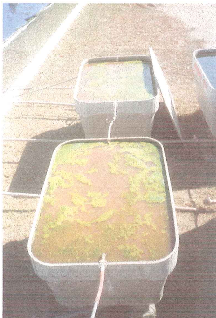
FIGURA 49 - Algas azuis (cianofíceas) na superfície dos tanques facultativos
