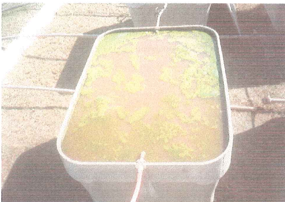
FIGURA 50 - Detalhe das algas no tanque facultativo
