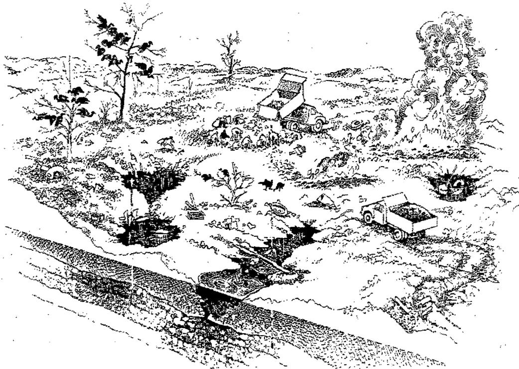
FIGURA 1.1 – Esquema de um lixão a céu-aberto mostrando a presença dos catadores e animais no local de descarga dos caminhões e o acúmulo de chorume na superfície do solo, bem como a sua absorção pelas camadas do solo.
