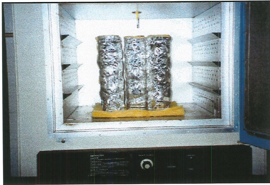
Figura 4.17- Montagem dos leitos de secagem, em escala de laboratório, em que foi utilizada secagem não-convencional (secagem em estufa).
