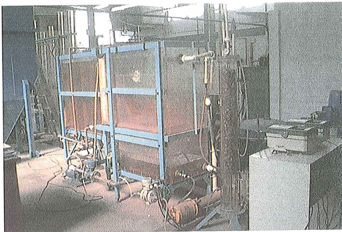
FIGURA 4.11 – Fotografia das instalações da unidade piloto de FAD de alta taxa com módulo.
