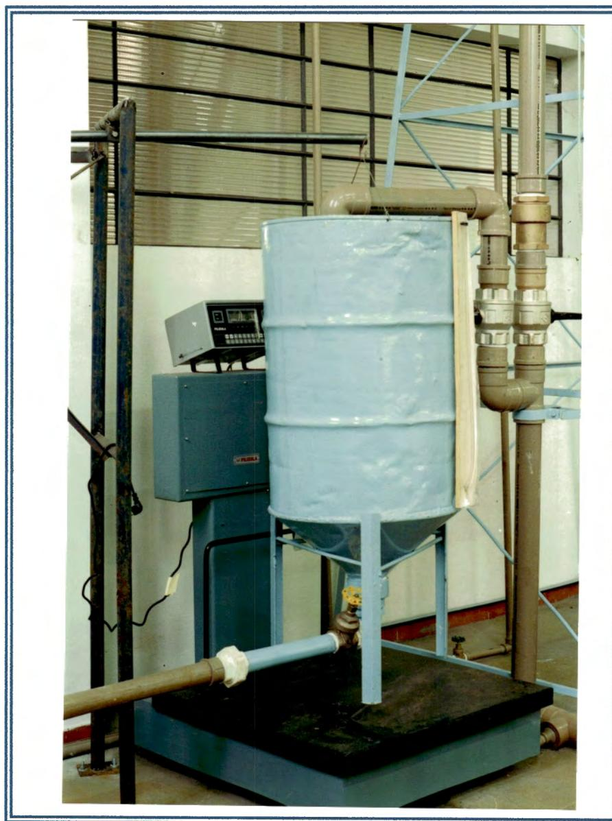
FOTO 5 - Balança eletrônica e reservatório para medidas gravimétricas
