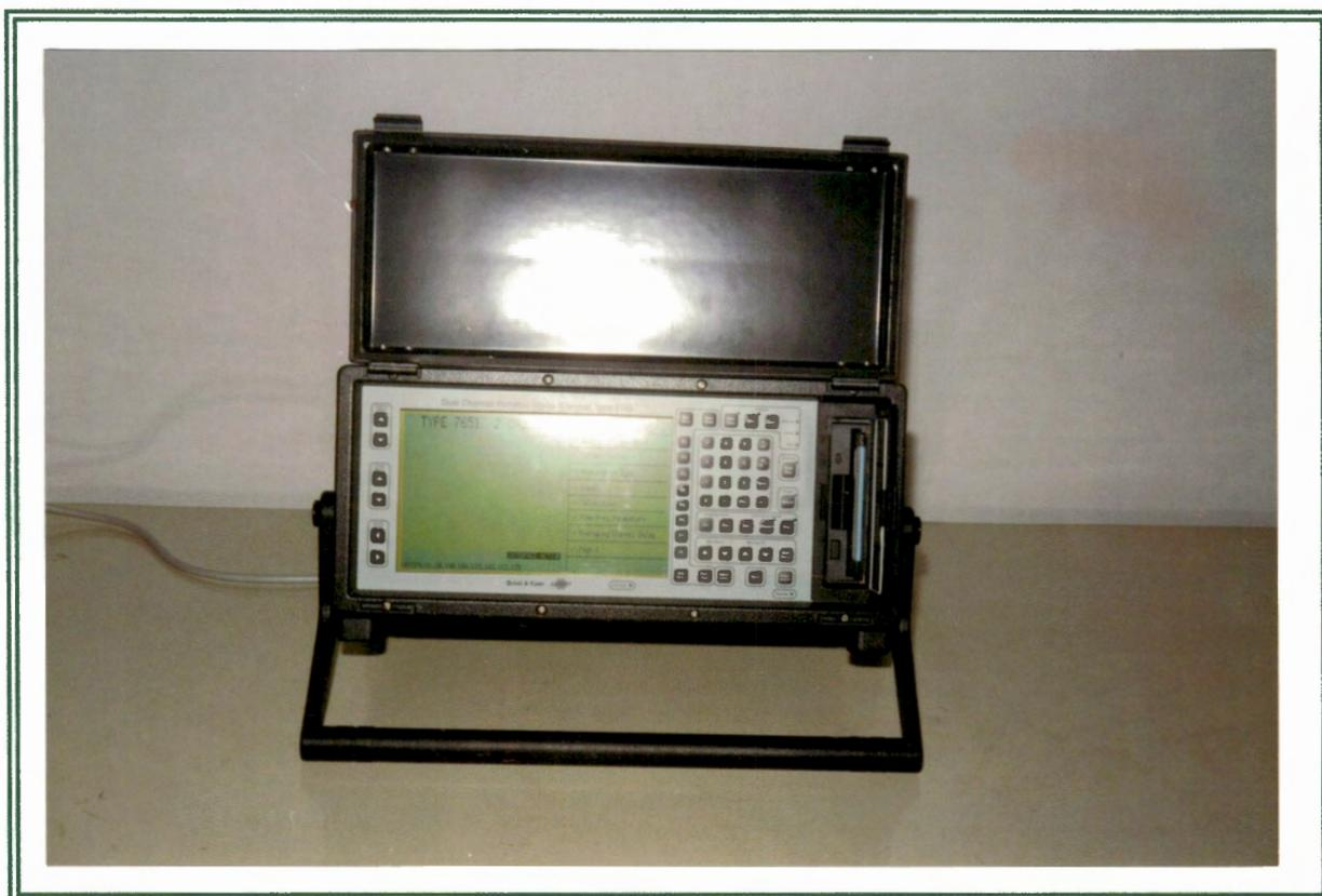
FOTO 10 - Analisador tipo 2148 de dois canais da marca Brüel & Kjaer
