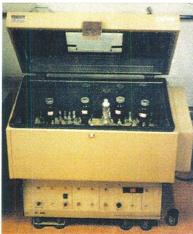
FIGURA 14: Agitador com temperatura controlada da marca Superohm modelo G-25.
