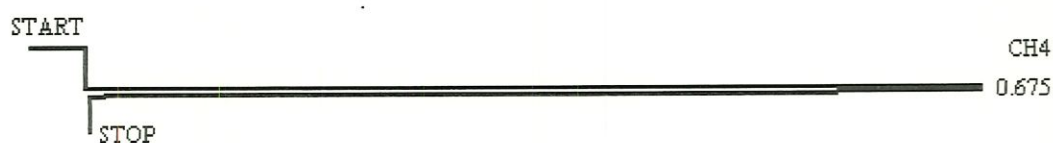
FIGURA 09: Cromatograma típico para a detecção do gás metano ( \text{CH}_4 ) no cromatógrafo HP5890.
