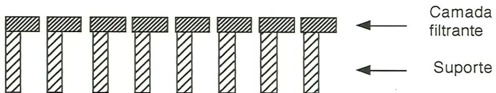
**FIGURA 3.7 - Estrutura esquemática de membrana “composite”**
