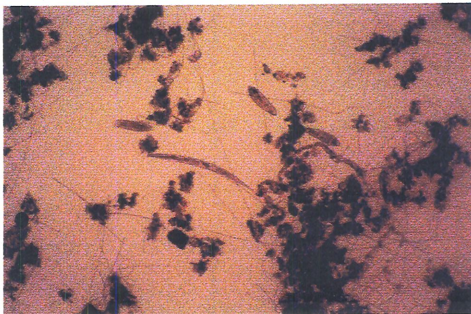
FIGURA 5.97 – Aspecto geral dos flocos, de amostras coletadas no “mixed liquor” do reator aeróbio compartimentado. Protozoários ciliados livre-natantes ( Paramecium ), protozoários ciliados fixos (pedunculados), verme cilíndrico com morfologia semelhante aos nematóides e filamentos com morfologia semelhante às bactérias do ciclo do enxofre (sulfobactérias). Fase 3, câmara 3. Aumento de 40 x
