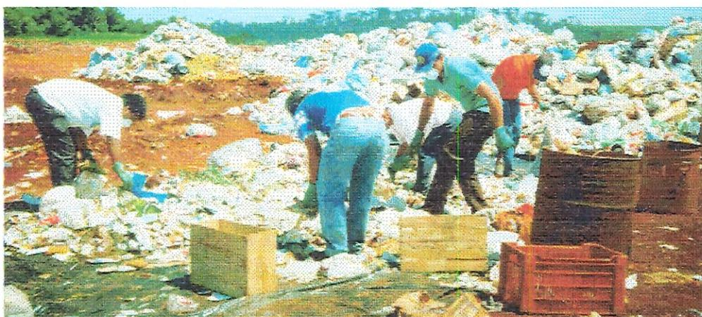
Figura 35- Triagem da amostra resultante do processo de quarteamento
