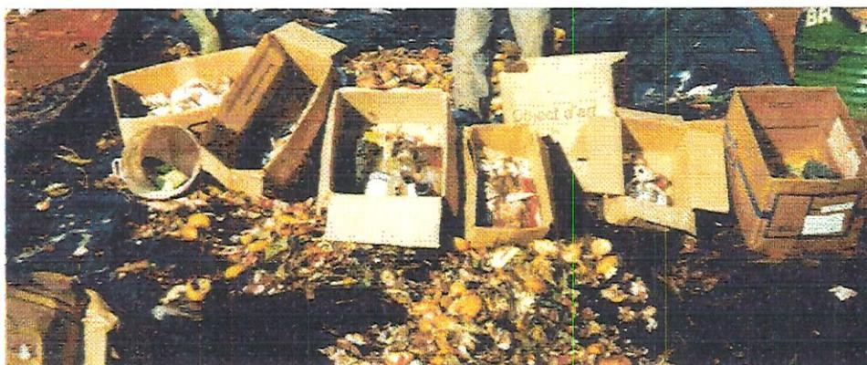
Figura 36 - Triagem dos resíduos, separando-os por tipo de material
