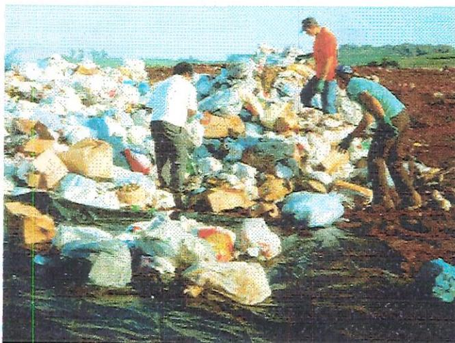
Figura 31 - Retirada de resíduos, em 5 pontos, para formação da pilha e extrair amostra representativa
