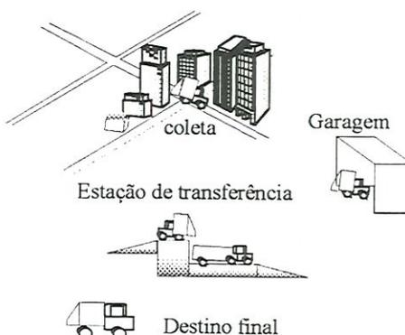
Figura 19 - Esquema do sistema de coleta com transporte intermediário para estação de transferência.
