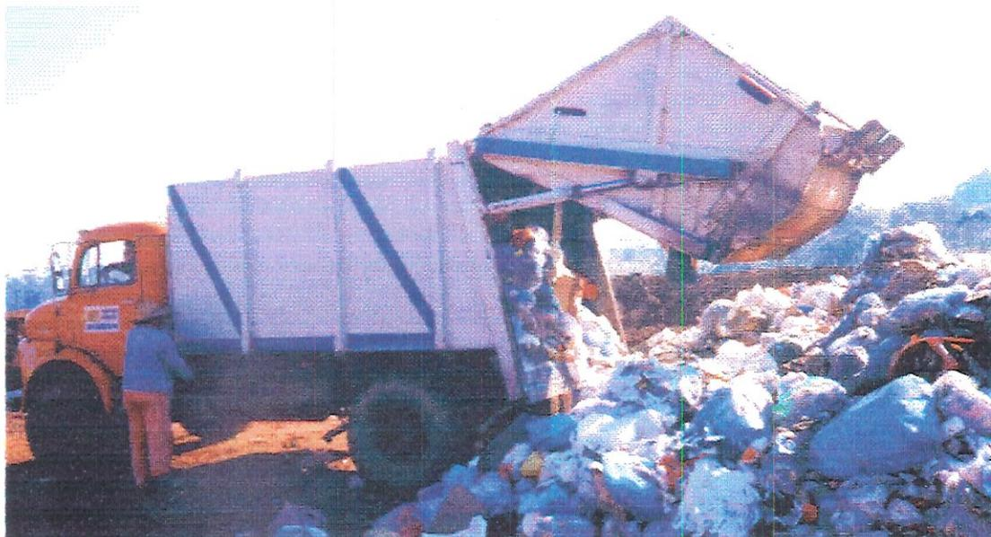
Figura 30 - Descarga de resíduos sólidos domiciliares pelo caminhão coletor, na área escolhida para a caracterização.
