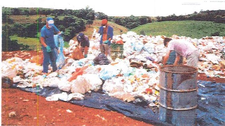
Figura 32 - Foto mostrando a retirada das amostras e preenchimento dos tambores, para determinação da densidade dos resíduos, em 19/07/96.
