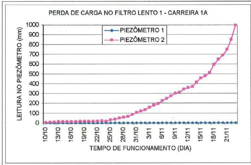
FIGURA C.49 – Perda de Carga no FL1 – carreira 1A
