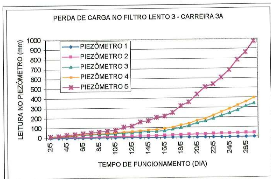
FIGURA C.67 – Perda de Carga no FL3 – carreira 3A
