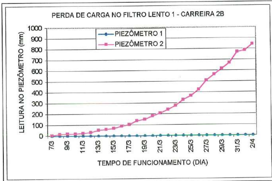
FIGURA C.61 – Perda de Carga no FL1 – carreira 2B
