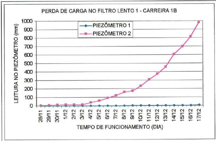
FIGURA C.53 – Perda de Carga no FL1 – carreira 1B
