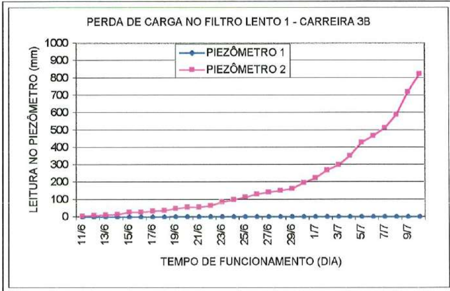
FIGURA C.69 – Perda de Carga no FL1 – carreira 3B
