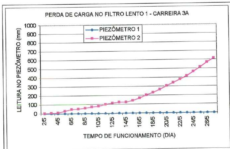
FIGURA C.65 – Perda de Carga no FL1 – carreira 3A
