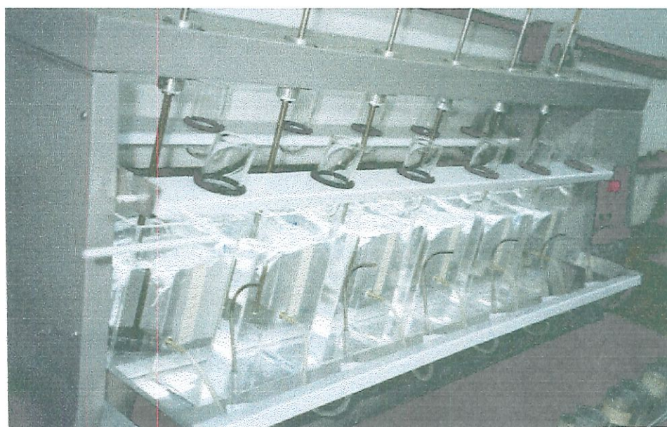
Figura 4.3 - Fotografia do equipamento de coagulação, floculação e sedimentação mostrando especificamente os dispositivos de adição de coagulante e coleta de amostra simultâneas.
