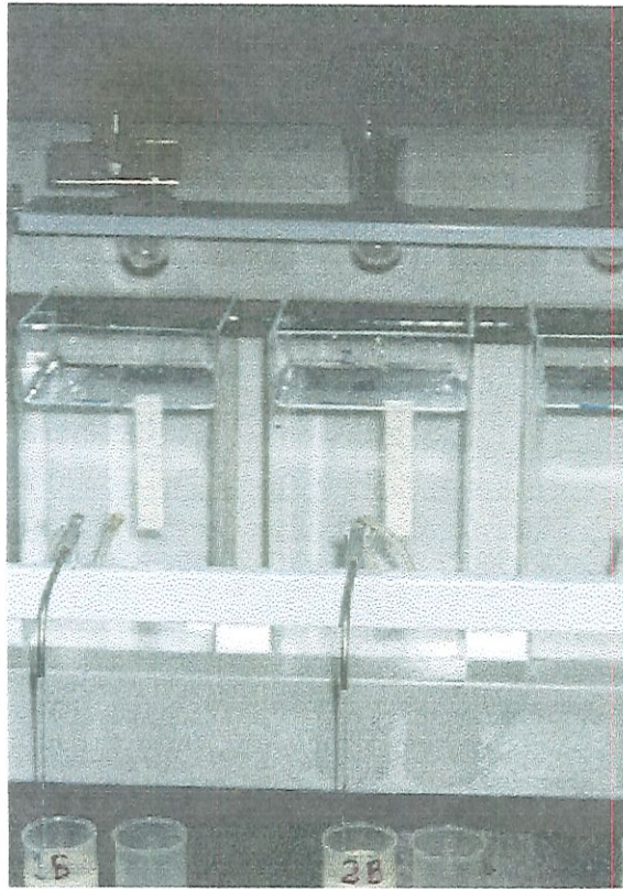
Figura 4.1 - Ponto de coleta de amostra situado a 70mm abaixo do nível d'água.
