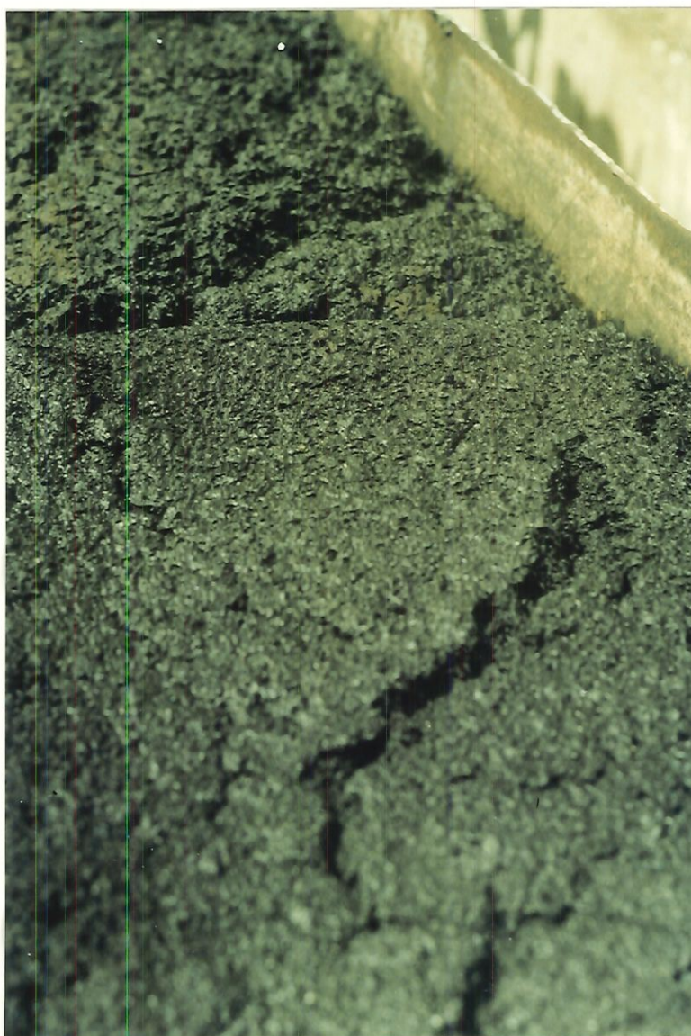
FIGURA 41 - Foto tirada durante o Ensaio 9, no dia 06/12/94, mostrando o aspecto do lodo flotado firme e espesso, como na maioria dos ensaios.
