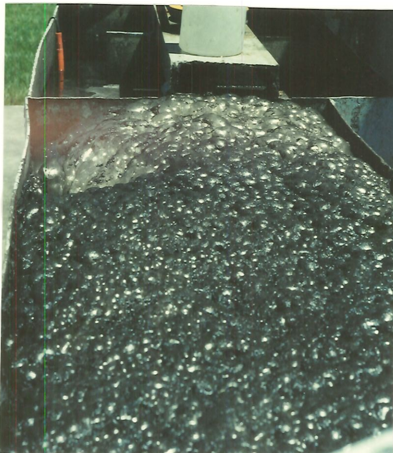
FIGURA 34 - Foto do Ensaio 12 (TAS = 200 \text{ m}^3/\text{m}^2\text{d} , Rec. = 126% e eficiência de 56,8% de remoção), realizado em 08/12/94, mostrando o colapso do ensaio devido a turbulência.
