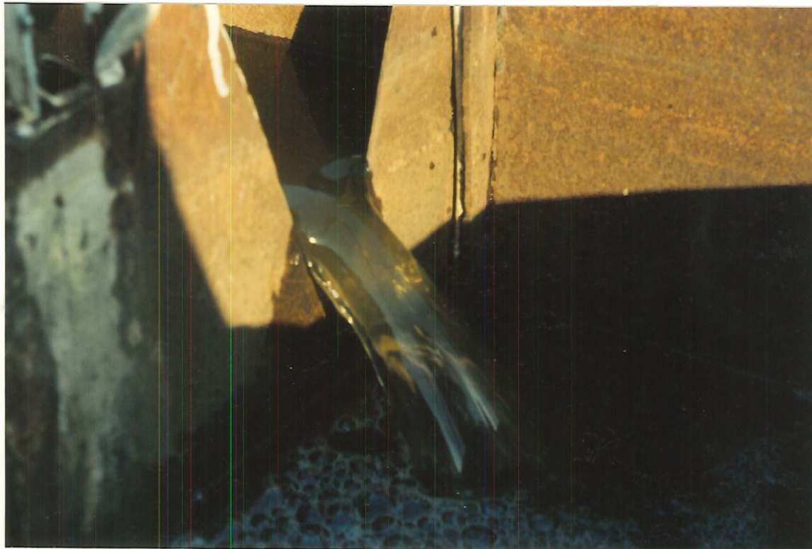
Figura 40 - Foto mostrando aspecto da água pré-tratada na unidade piloto de FAD no Ensaio 15, realizado em 17/08/95, mostrando a eficiência do uso de cloreto férrico.
