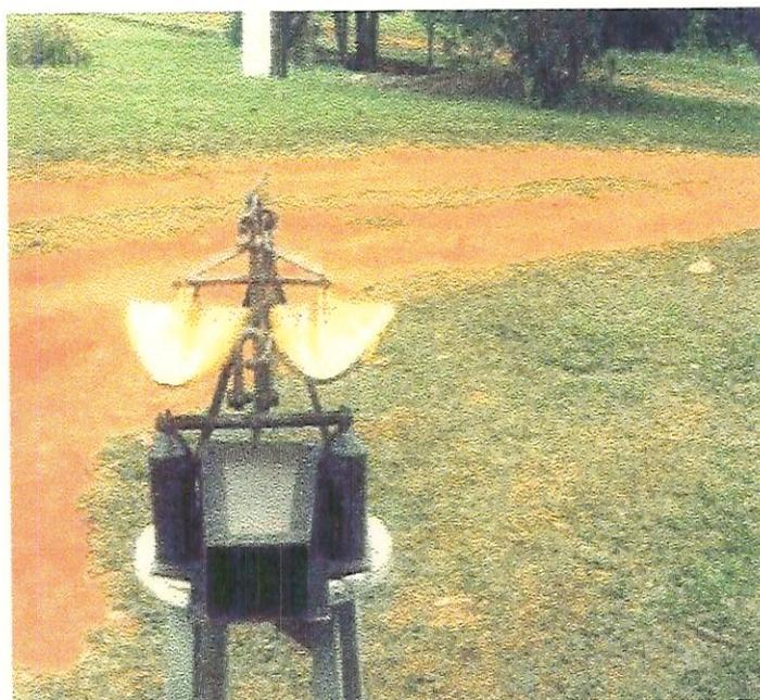
Figura 3.17b - Amostrador de material de fundo tipo holandês AMF-4
