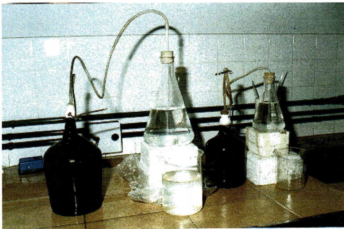
FIGURA 4.11 - Montagem para adaptação do lodo anaeróbio.
