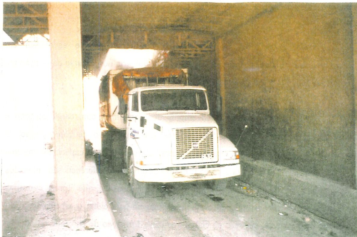
FIGURA 29 - Estação de transferência Caju (rampa): área de carregamento dos veículos de transporte.
