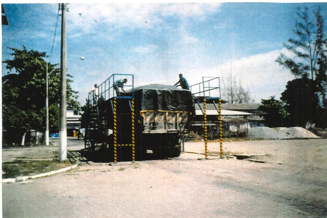
FIGURA 30 - Estação de transferência Bangu: área de enlonamento dos veículos de transporte.
