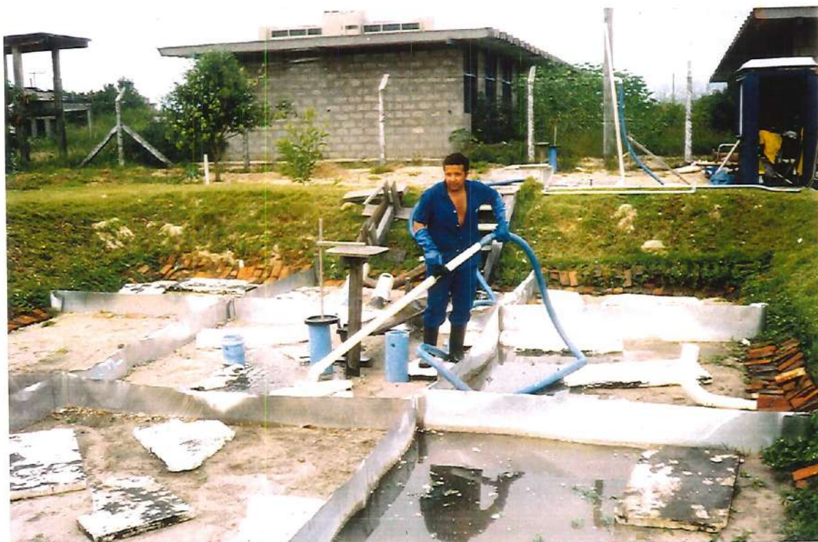
FIGURA A35 - Foto: Aplicação por pressão em células.
