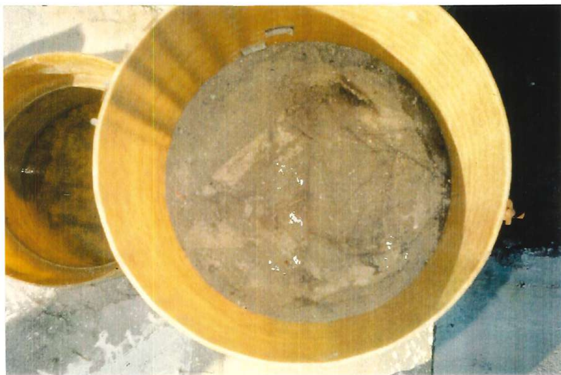
FIGURA 4.3 - Foto: Colmatação: vista de cima da película colmatante após lançamento 75cm de esgoto bruto.
