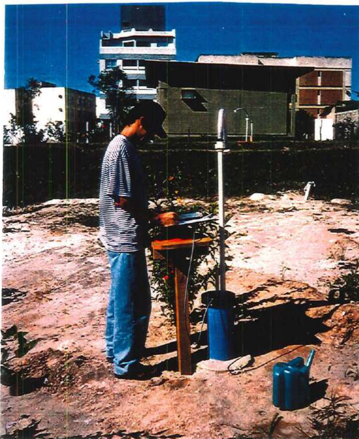
FIGURA A51 - Foto: Leitura de condutividade no Poço D.
