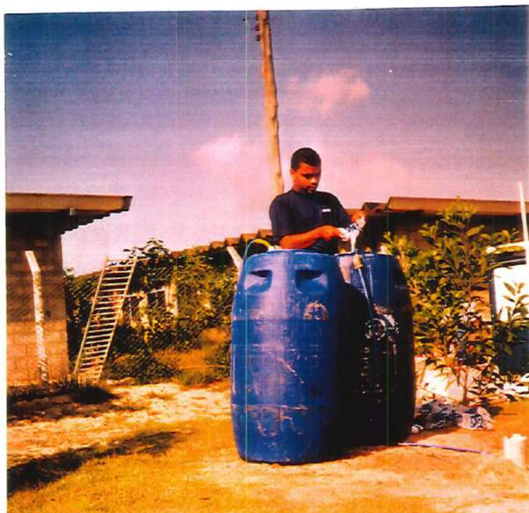
FIGURA A49 - Foto: Diluição de cloretos nas bombonas.
