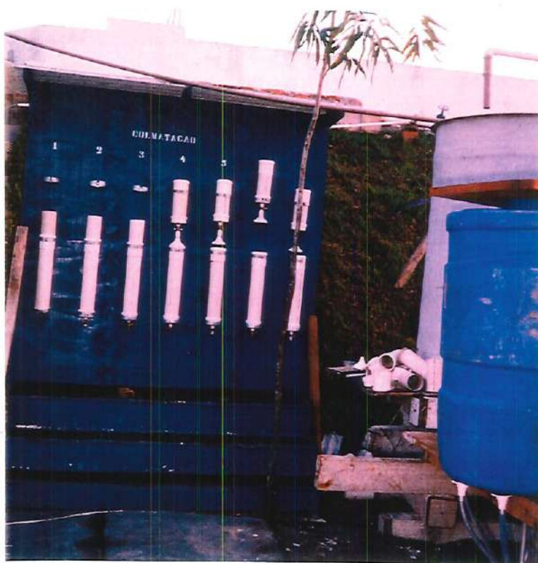
FIGURA A53 - Foto: Reatores, abrigados do sol e da chuva utilizados nos estudos de colmatação por SIMÕES et al (1996).
