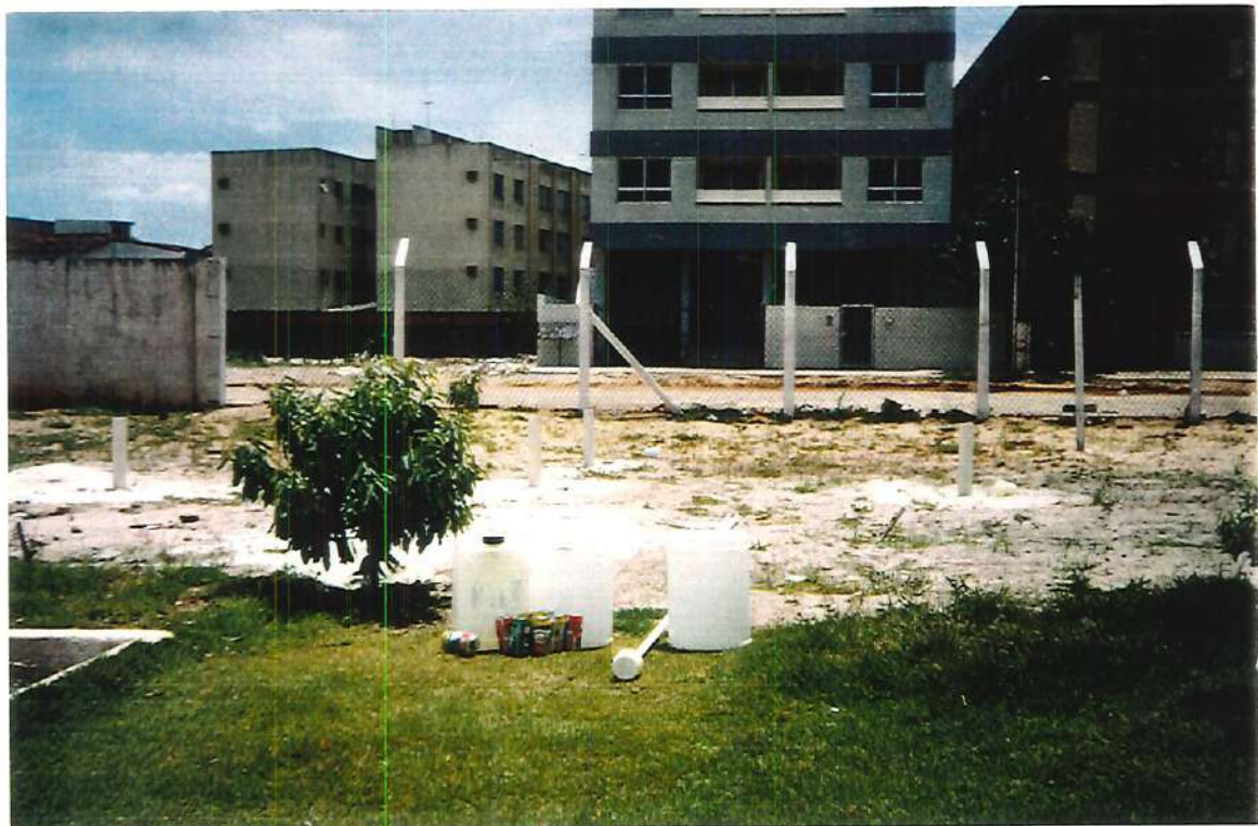
FIGURA A11 - Foto: Bombonas de solução, coletor de amostras nos piezômetros e vasilhames utilizados na coleta de amostras para análise de cloretos.
