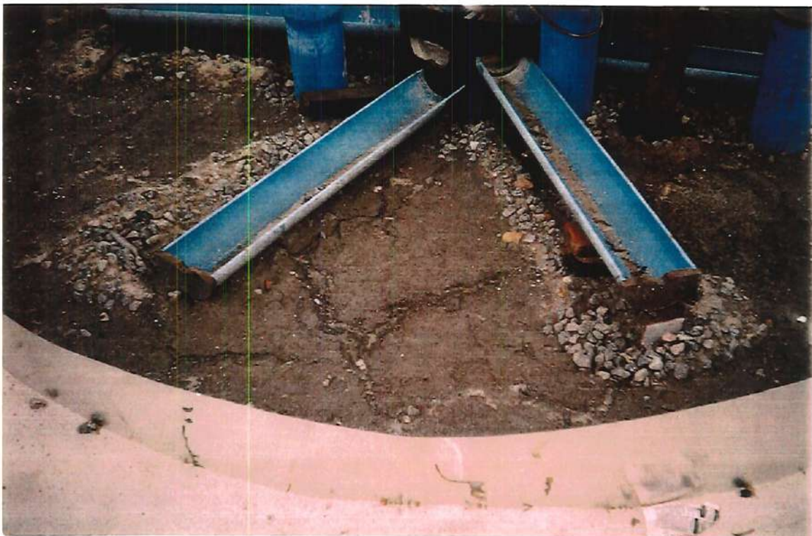
FIGURA A28 - Foto: Início da degradação da camada colmatante. Quarto dia após aplicação.
