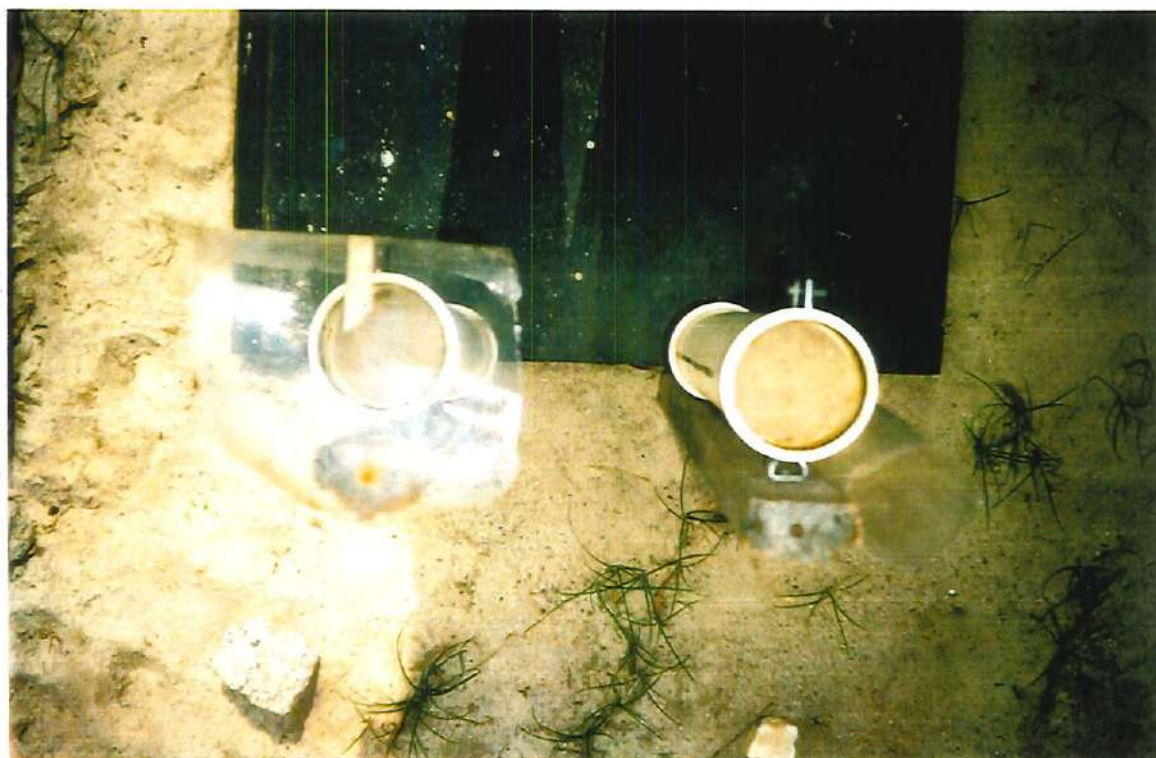
FIGURA A54 - Foto: Reatores expostos ao sol e à chuva utilizados nos estudos de colmatação por SIMÕES et al (1996).
