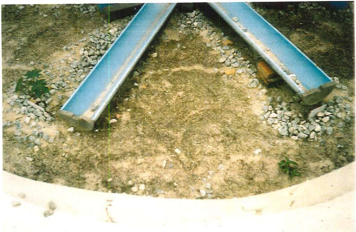
FIGURA A31 - Foto: Colmatação na BIE no quarto dia após aplicação de esgoto e após uma chuva.
