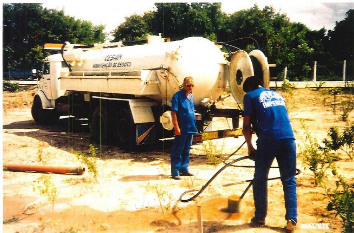
FIGURA A48 - Foto: Cravação do poço D. Diferença de cor da água de PD em relação à cor da água do poço E.
