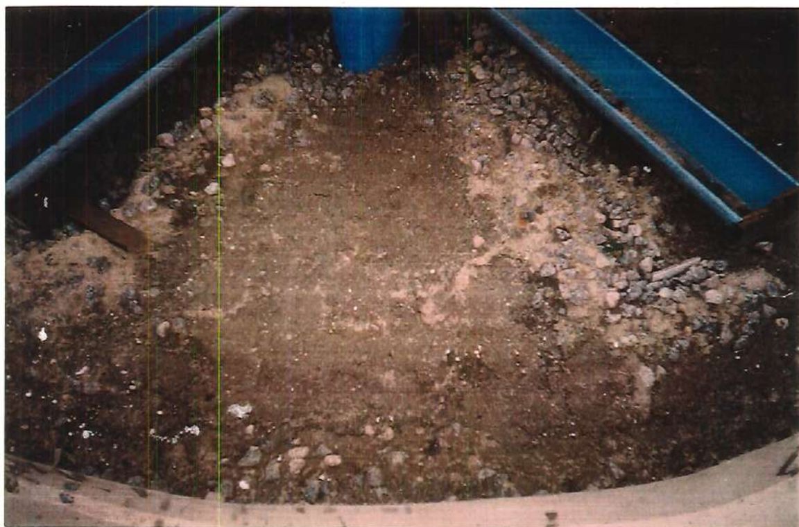
FIGURA A29 - Foto: Estado de degradação da camada colmatante no sexto dia após a primeira aplicação do ciclo.
