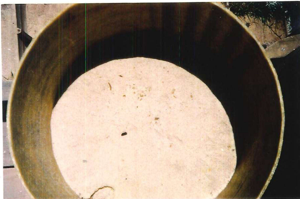
FIGURA 4.2 - Foto: Superfície do TQC1 antes da aplicação do esgoto (areia virgem).
