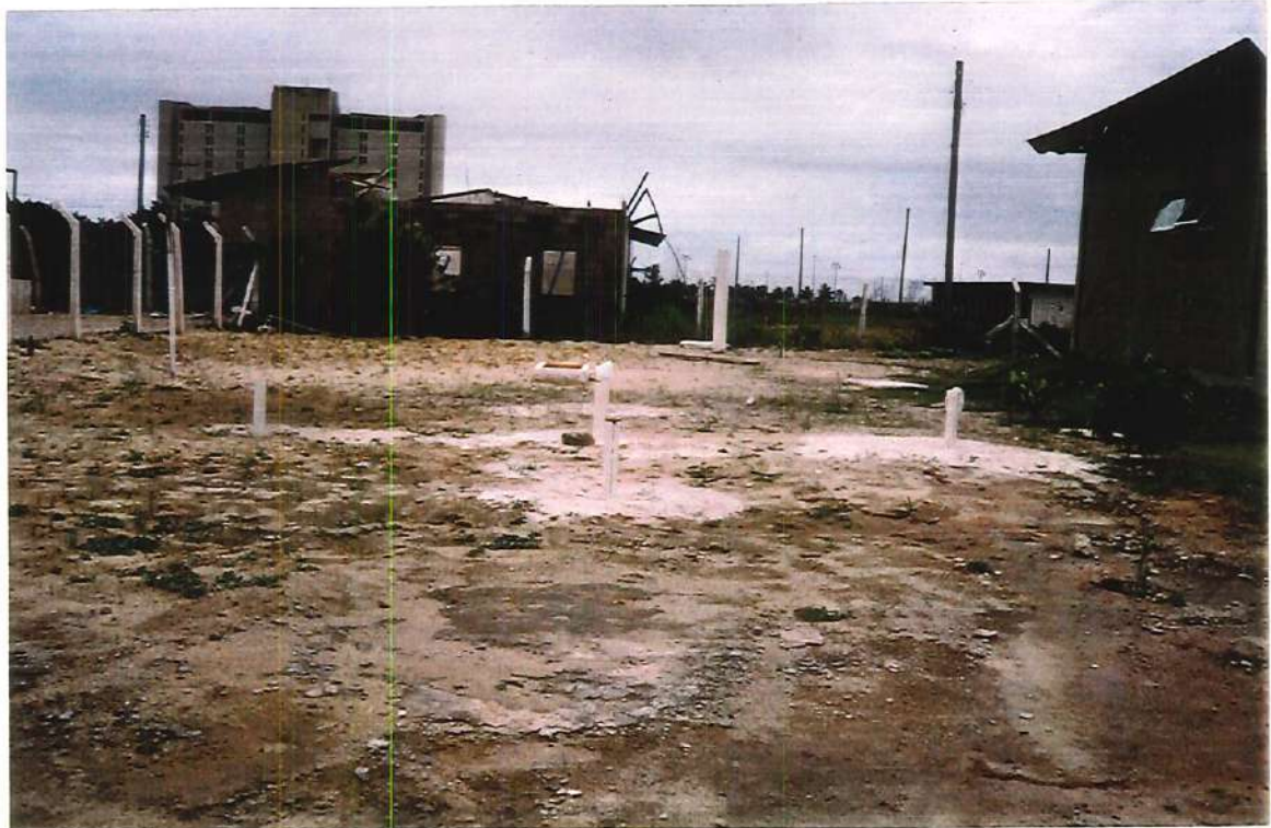
FIGURA A10 - Foto: Rede de piezômetros Pz1, Pz2, Pz3, Pz4 e Pz5, utilizada na definição preliminar da direção do escoamento, tendo-se ao fundo a topografia da área da FIGURA A12.
