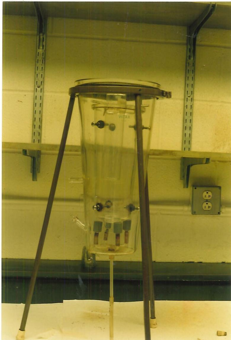
**Figura 3.4.:** Vista do reator montado: 3 compartimentos e os 4 difusores de ar ao fundo
