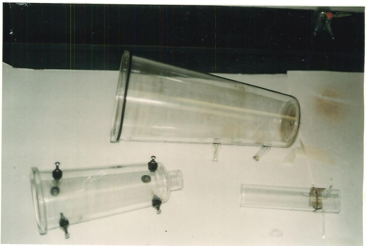
Figura 3.3.: Vista do reator desmontado: 3 compartimentos que formam o conjunto de bio-oxidação
