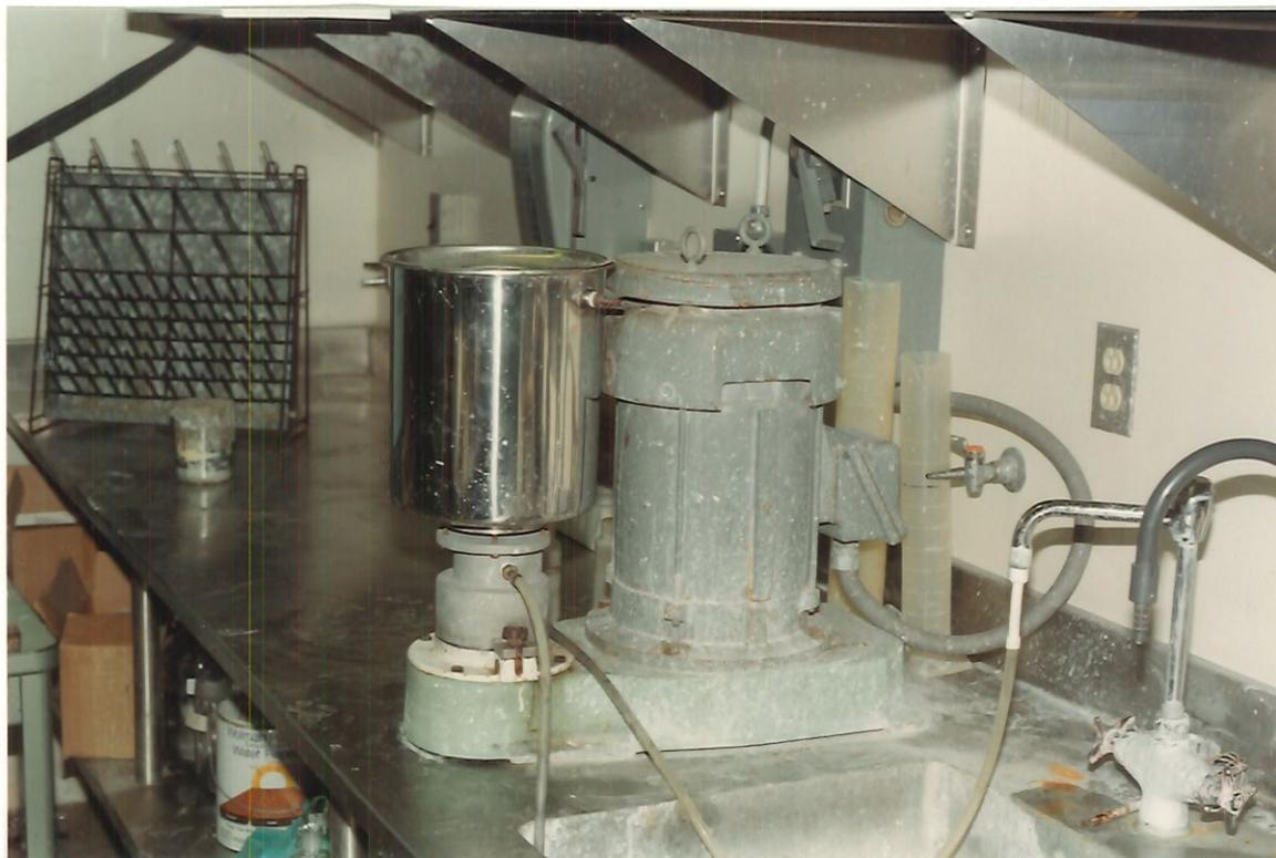
**Figura 3.7.:** Vista lateral do equipamento *Kady mill* utilizado para fazer a lise celular do lodo.
