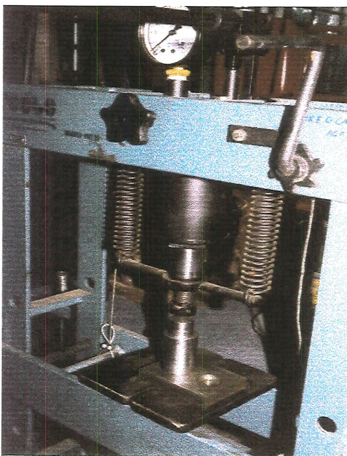
FIGURA 3.1 - Prensa hidráulica manual e matriz para prensagem de compactação.
