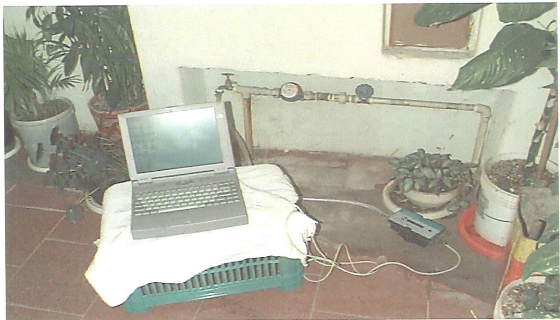
FIGURA 3.2 – Computador portátil utilizado para extração de dados armazenados em campo através de data loggers .
