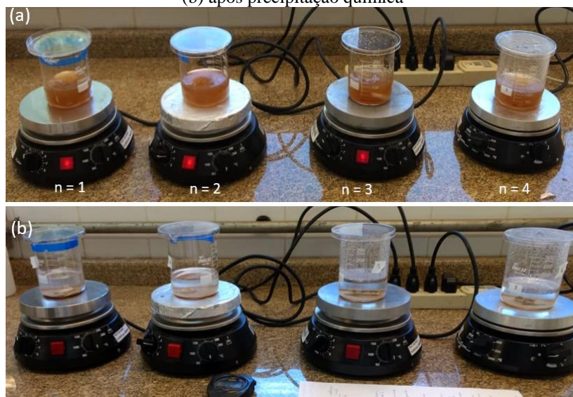
Figura 2- Amostras de lodo com inóculo de protozoário para concentração por FCCa: (a) sob agitação; (b) após precipitação química
