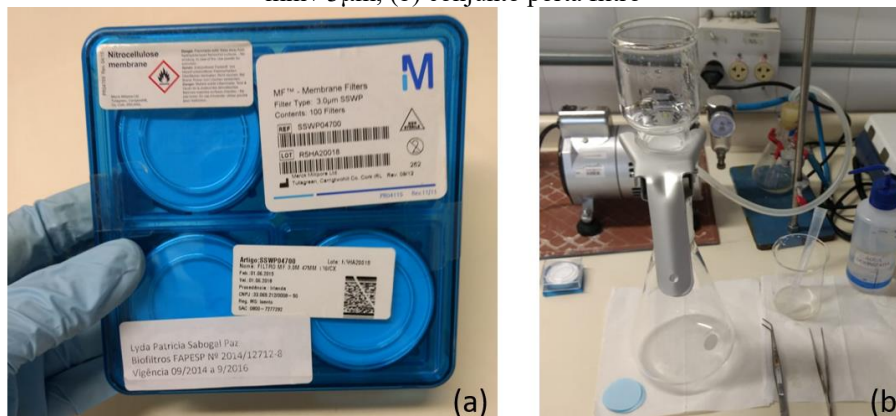
Figura 4 - Itens aplicados na concentração de protozoários por FM: (a) Membranas de ésteres de celulose - 47 mm / 3 \mu\text{m} ; (b) conjunto porta filtro
