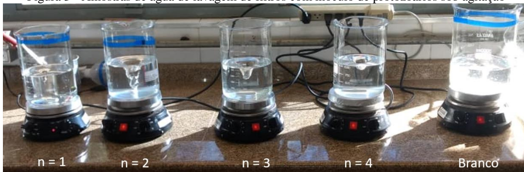
Figura 3 - Amostras de água de lavagem de filtros com inóculo de protozoários sob agitação
