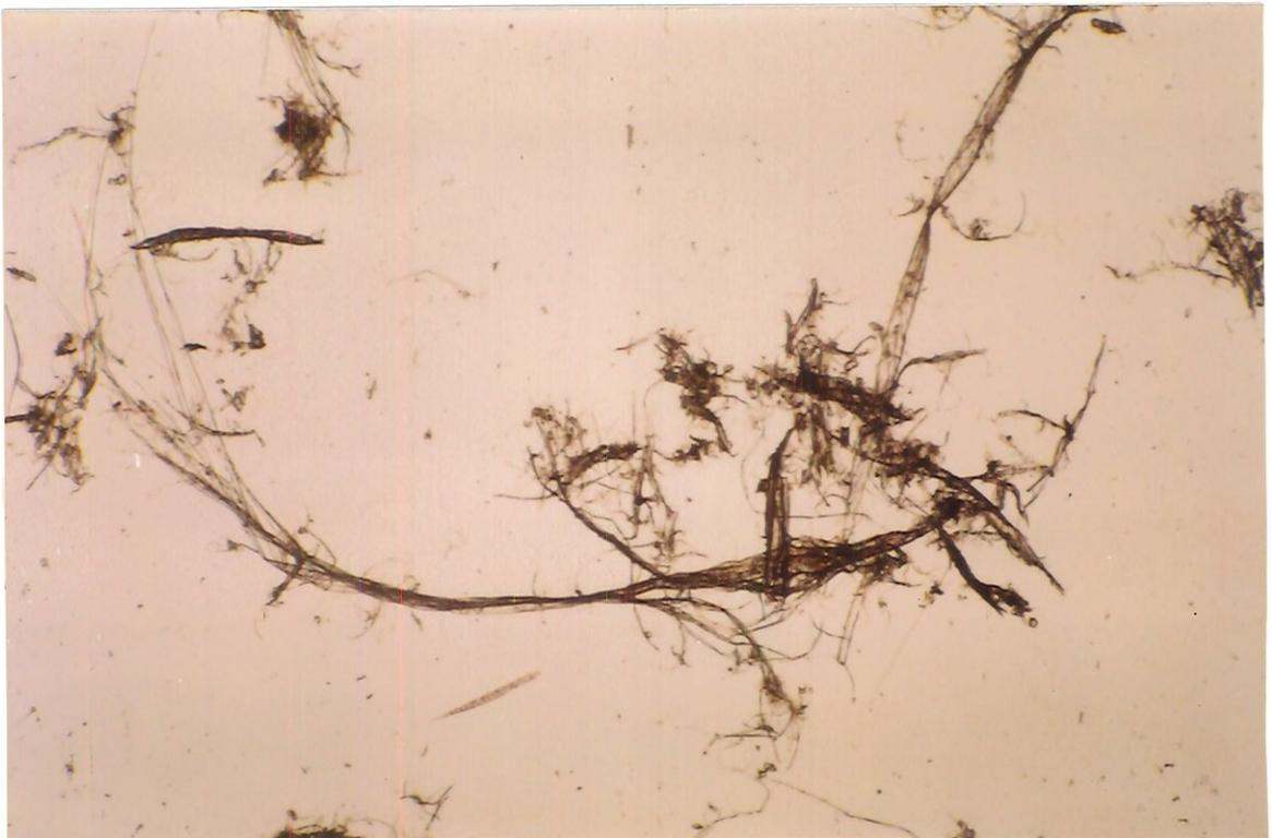
Figura 4.7 - Fotomicroscopia ótica do lodo preparado(ampliação de 50 vezes).
