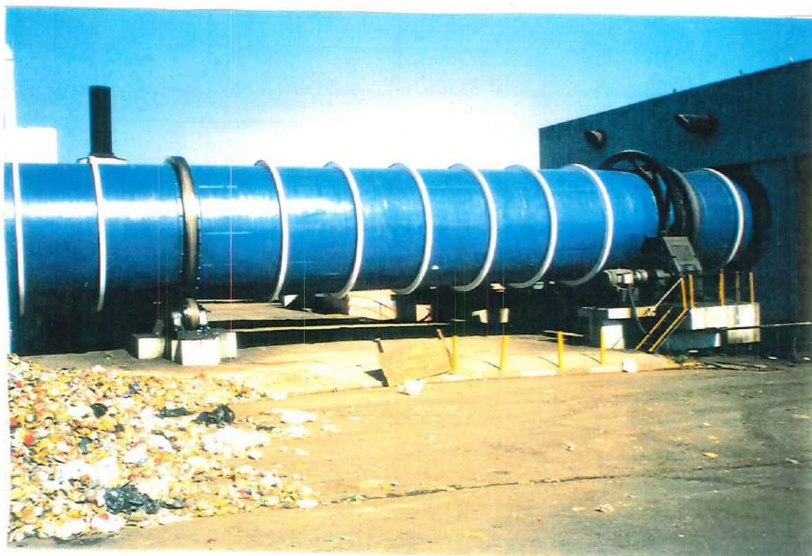
FIGURA B42 - Bioestabilizador e prédio de saída dos bioestabilizadores (São Matheus - SP).
