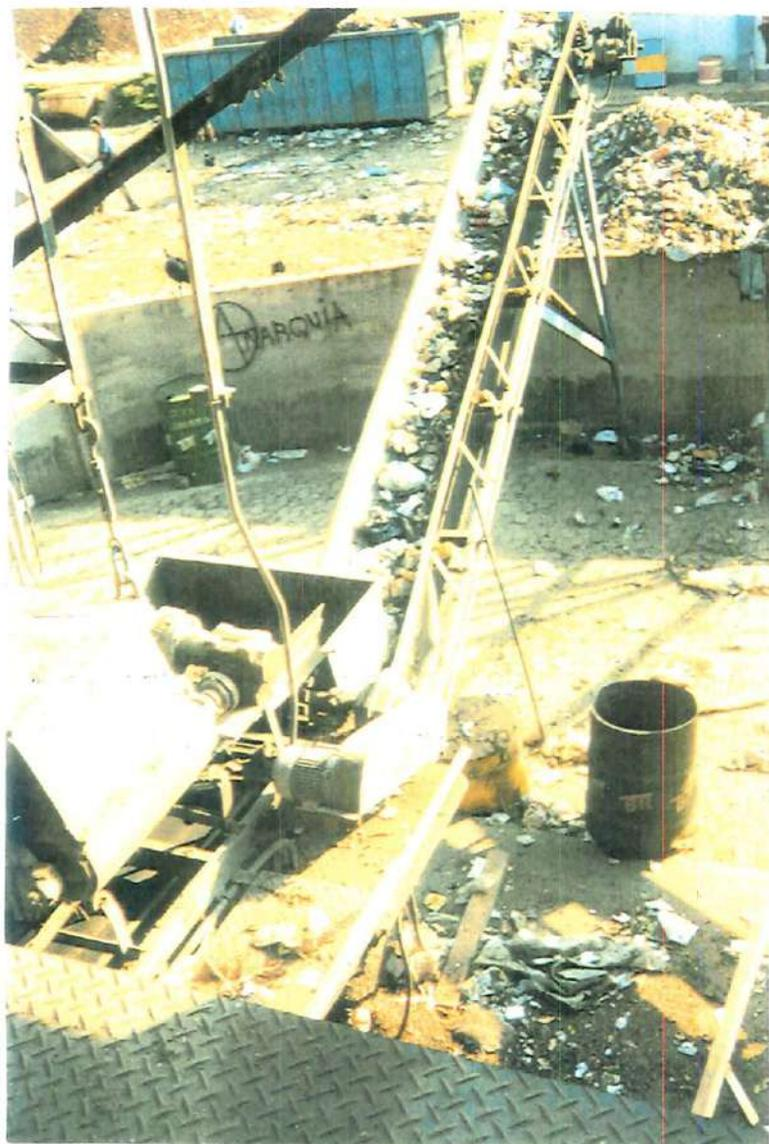
FIGURA B55 - Saída do moinho, eletroímã e esteira transportadora do terminal de composto (Vitória - ES).
