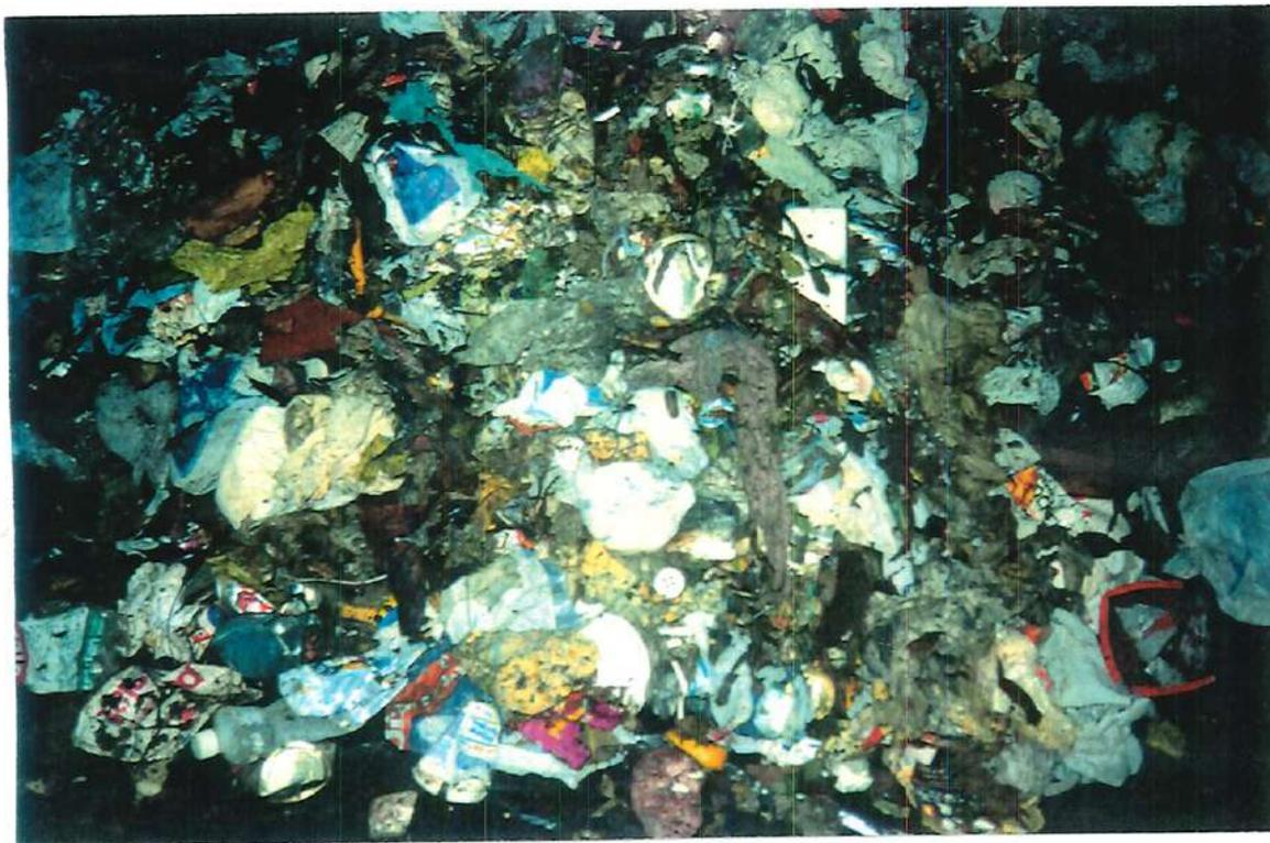
FIGURA B65 - Amostragem dos resíduos sólidos da linha de catação primária para caracterização física (Jacareapguá - RJ).
