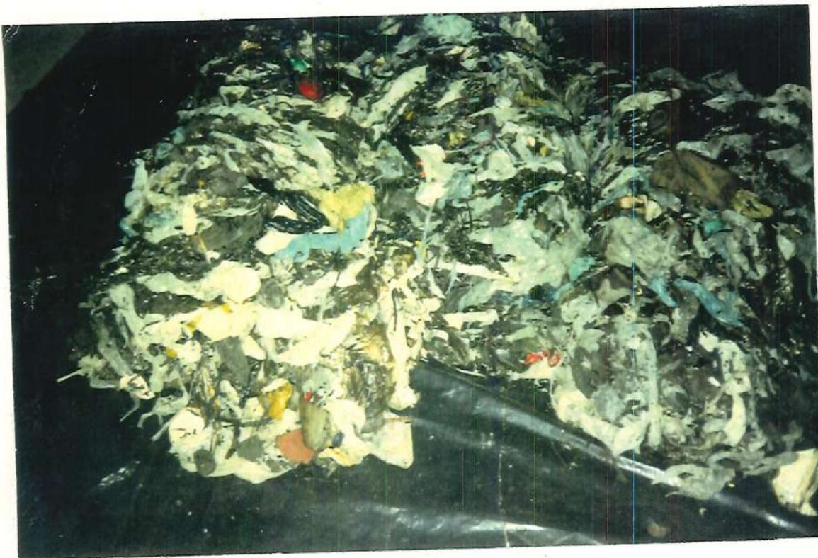
FIGURA B69 - Amostragem dos resíduos sólidos da linha de catação secundária para caracterização física (Jacarepaguá - RJ).
