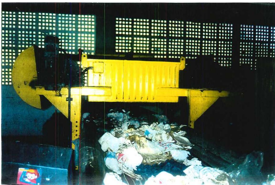
FIGURA B8 - Eletroíma da mesa de catação primária (Jacarepaguá - RJ).
