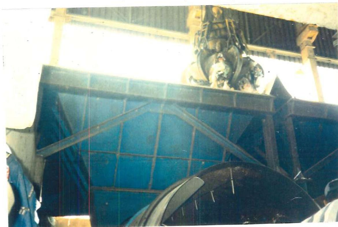
FIGURA B51 - Garra tipo pólipo alimentando as moegas de alimentação do processo (Vitória - ES).
