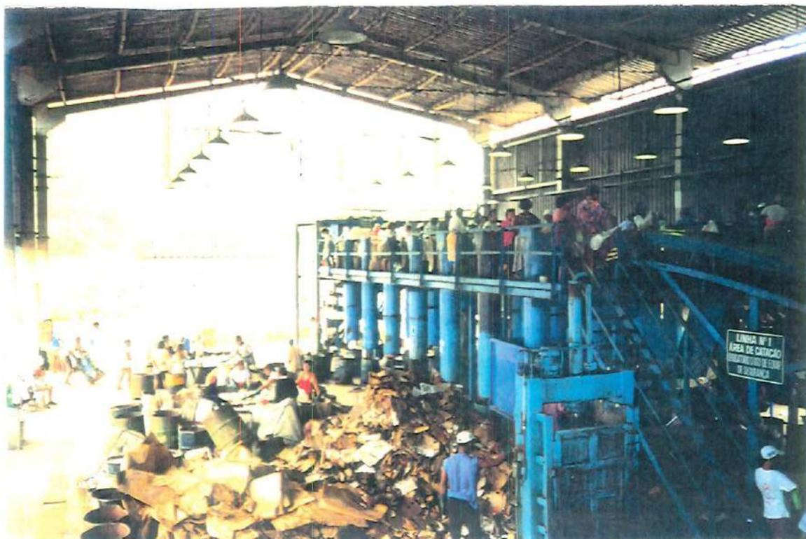
FIGURA B56 - Vista lateral da mesa de catação, dutos de transporte, mesas de separação de recicláveis e prensa (Vitória - ES).
