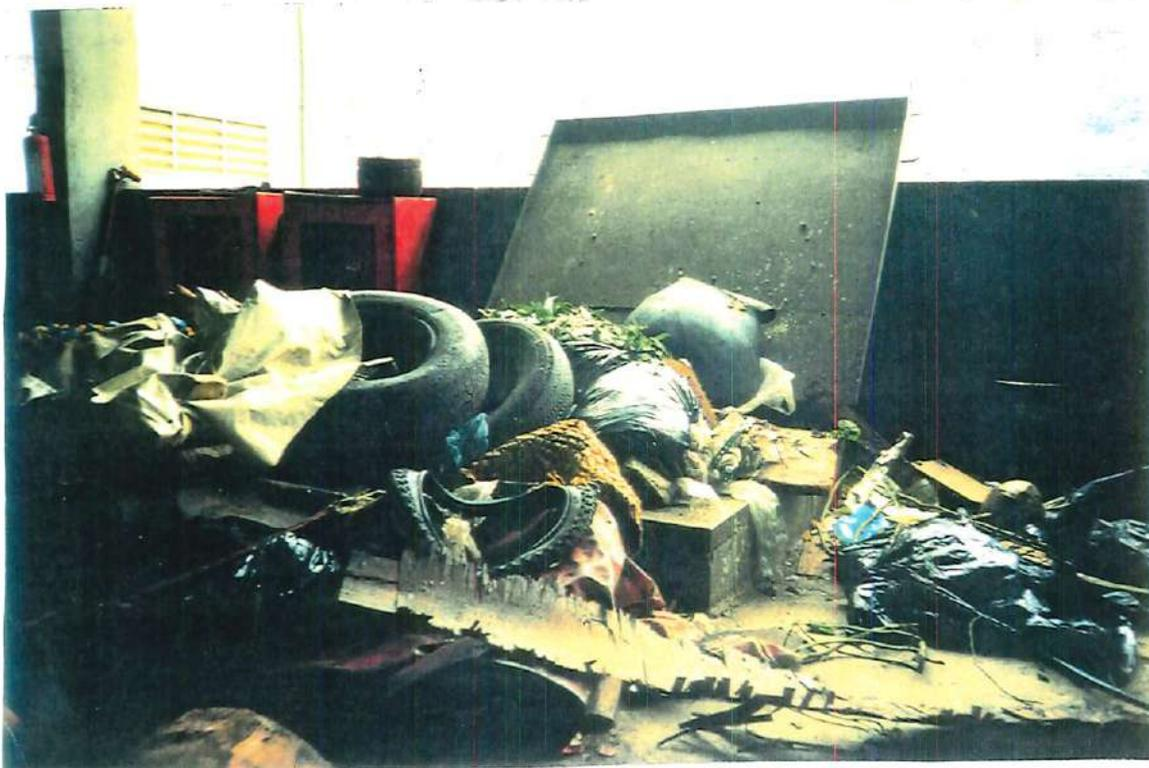
FIGURA B10 - Resíduos causadores de entupimento das linhas e acumulados na entrada da moega de transferência (Jacarepaguá - RJ).
