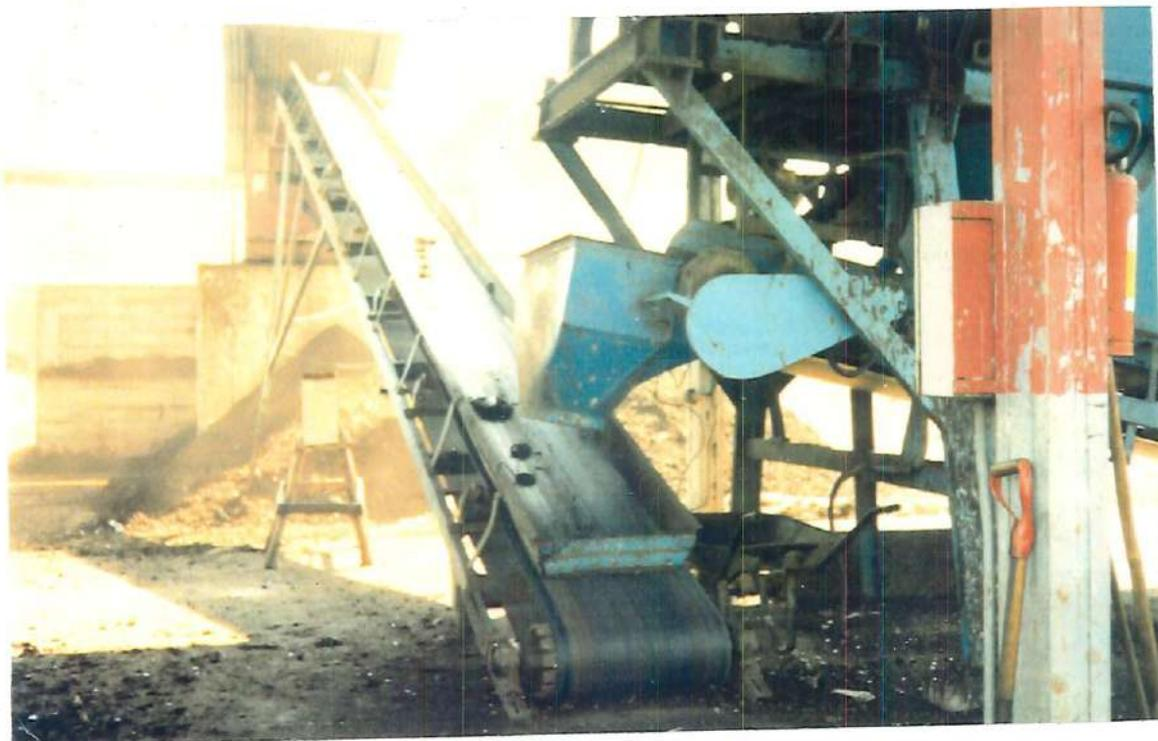
FIGURA B63 - Saída do composto da peneira rotativa e esteira transportadora de alimentação da peneira vibratória (Vitória - ES).
