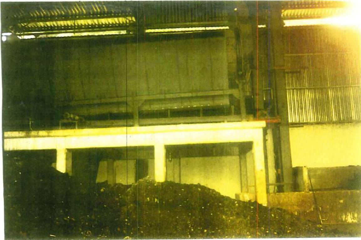
FIGURA B25 - Moega de alimentação, peneira rotativa, e transportador de canecos-setor de beneficiamento do composto (Jacarepaguá - RJ).
