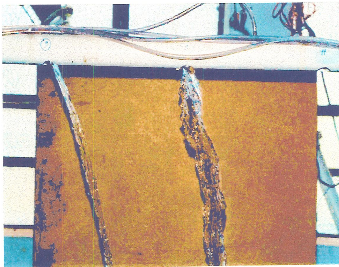
FIGURA 59 - VAZÃO DE DESCARGA NO 10º ORIFÍCIO PARA D = 38.5\text{mm} ; d = 26,20\text{mm} ; N = 10
